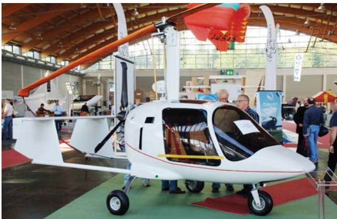
הגיירוקופטר קסנון מתוצרת גרמניה. כלי-הטיס הזעיר מצויד ברוטור הסובב חופשית ובמדחף המונע על-ידי מנוע רוטקס בן 100 כ"ס.
