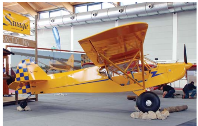
המטוס הזעיר Savage מתוצרת החברה הצ'כית זלין הוצג עם גלגלים מיוחדים שמאפשרים לו לפעול ממנחתים בלתי מוכשרים המכוסים באבנים.
