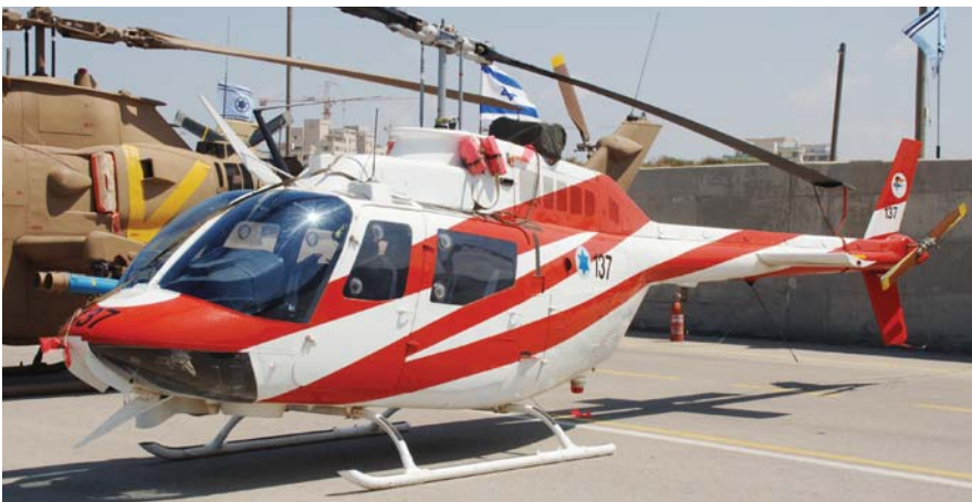
ההבדל החיצוני הבולט ביותר בין הדגם האזרחי לדגם הצבאי של ה בל 206 הוא בגודל חלונות הצד וצורתם. למעלה: סייפן מהדגם הצבאי OH-58B . למטה: סייפן מהדגם האזרחי שיוצר באיטליה – AB-206A .
