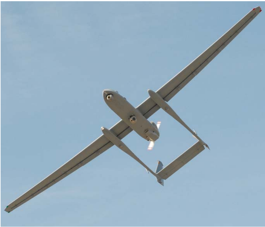
לשובל כרנסע מתקפל. הוא נושא שתי מערכות תצפית אלקטרו-אופטיות מיוצבות בגחונו.
