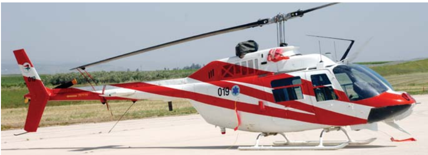
ההבדל החיצוני הבולט ביותר בין הדגם האזרחי לדגם הצבאי של ה בל 206 הוא בגודל חלונות הצד וצורתם. למעלה: סייפן מהדגם הצבאי OH-58B . למטה: סייפן מהדגם האזרחי שיוצר באיטליה – AB-206A .
