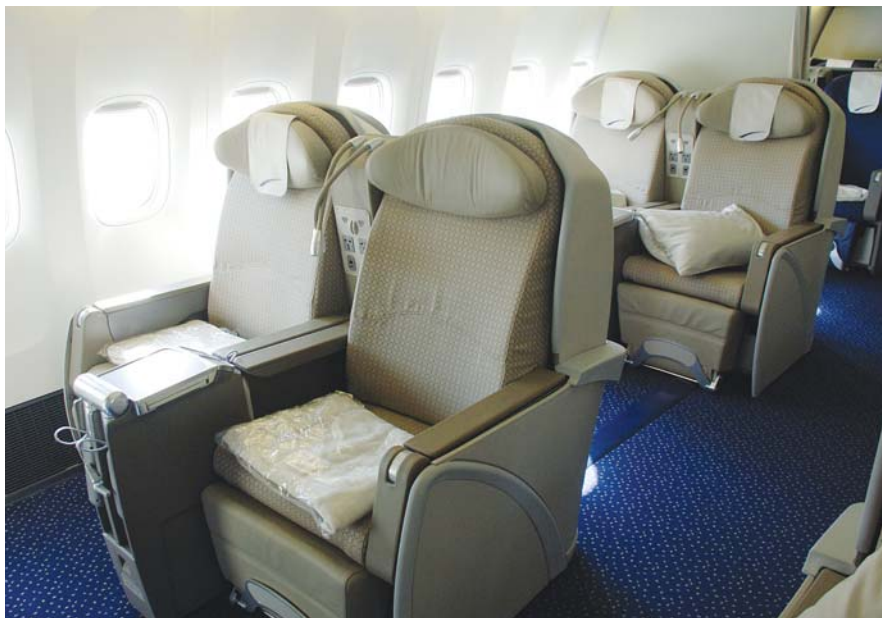
המושבים במחלקה ראשונה נשכבים למיטה שטוחה. למטה: המושב במחלקת עסקים נשכב ב-170 מעלות.
