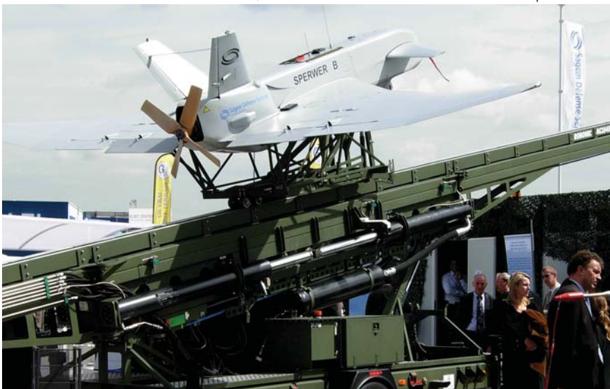
הכטב"ם הטקטי ספרוור B מתוצרת חברת סאג'ם הצרפתית על המשגר הגדול שלו.
