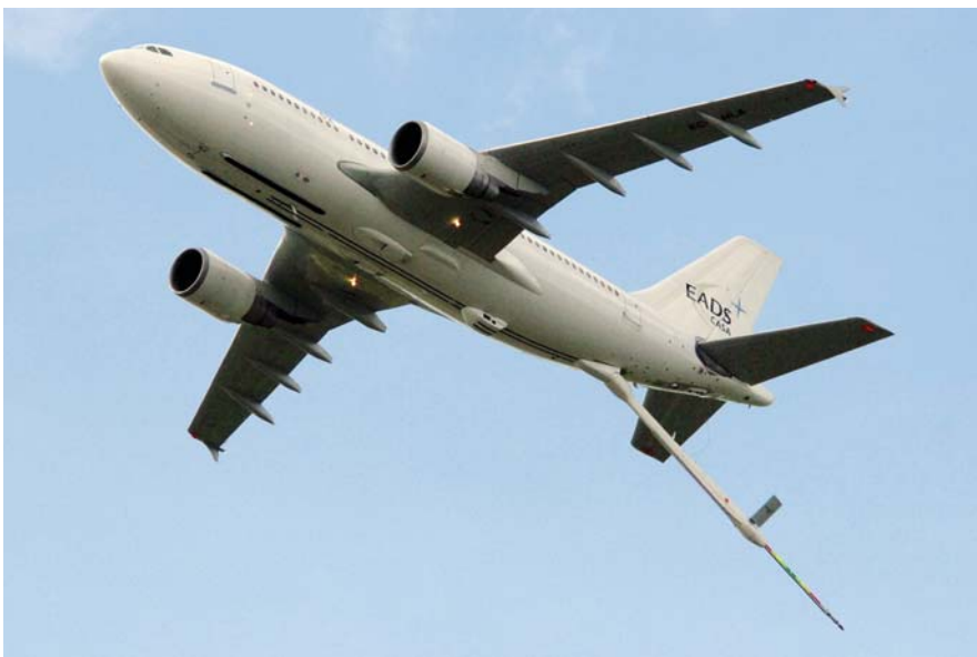
האייירבאס A310 שמשמש כמטוס ניסוי לבדיקת מערכת המנור המעופף ("בוס") לתדלוק באוויר.
