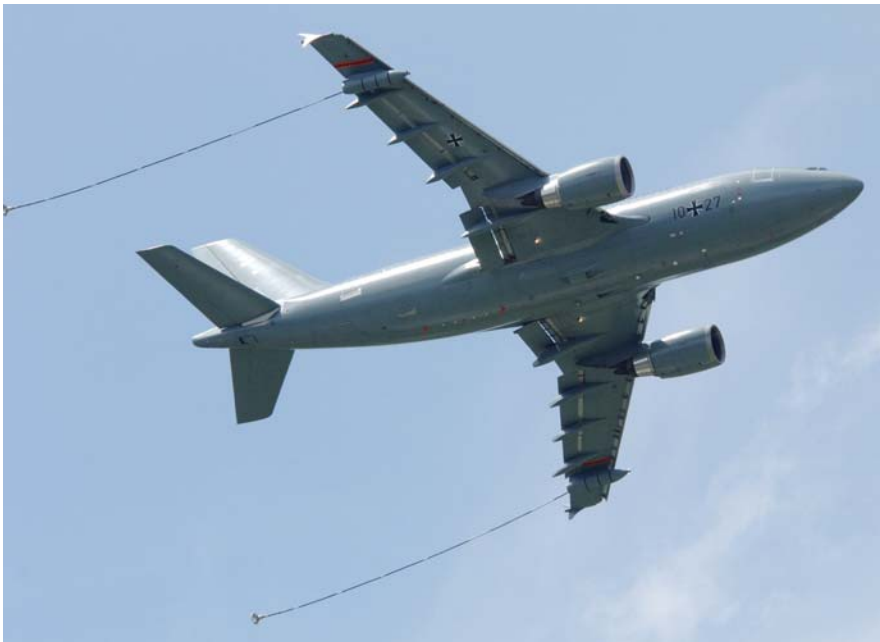
אייירבאס A310 MRTT של חיל האוויר הגרמני עם שני מארזי תדלוק בשיטת החדק והסל מתחת לכנפיים.
