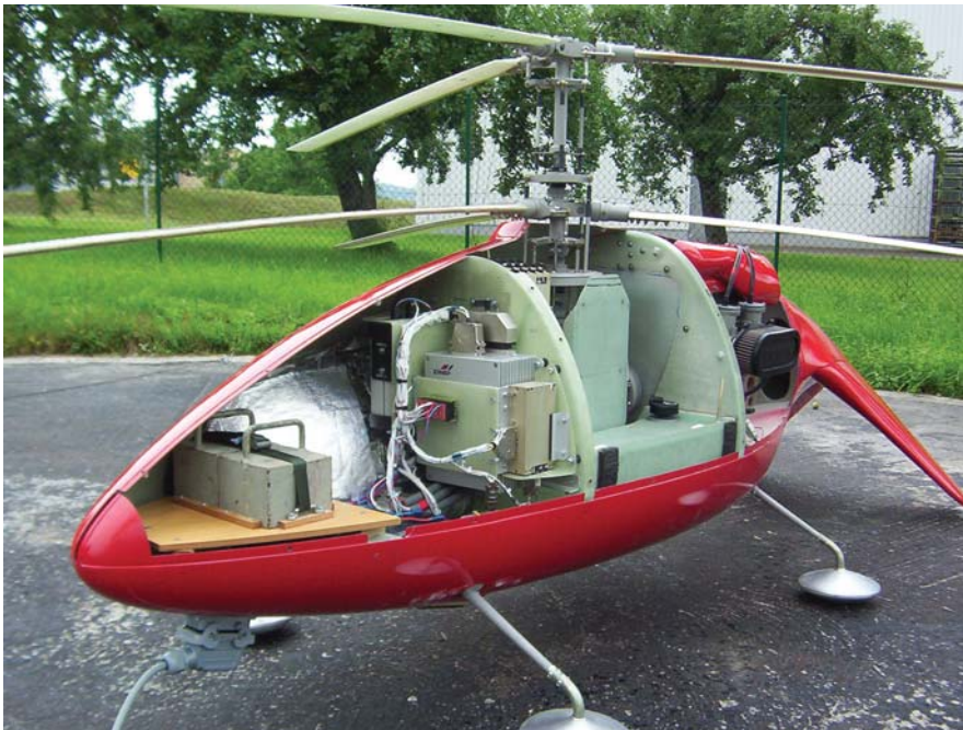
למעלה: השארק מתוצרת EADS בעל צמד הרוטורים הראשיים. למטה: חברת סאאב השוודית הציגה את הכטב"ם הרוטורי החדש סקלדאר.
