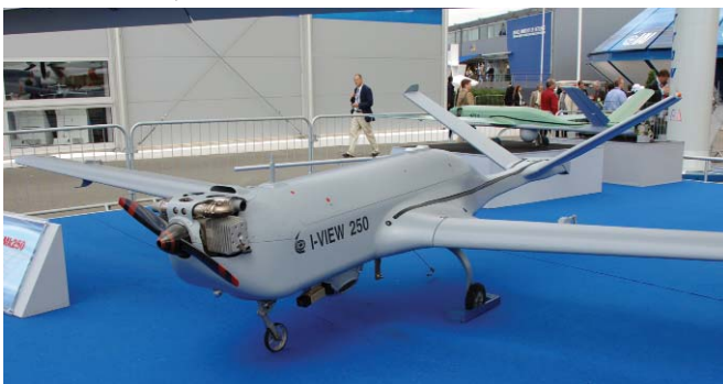
הדגם הגדול יותר I-View 250. כטב"מים אלה נוחתים באמצעות מצנח פאראפול.
