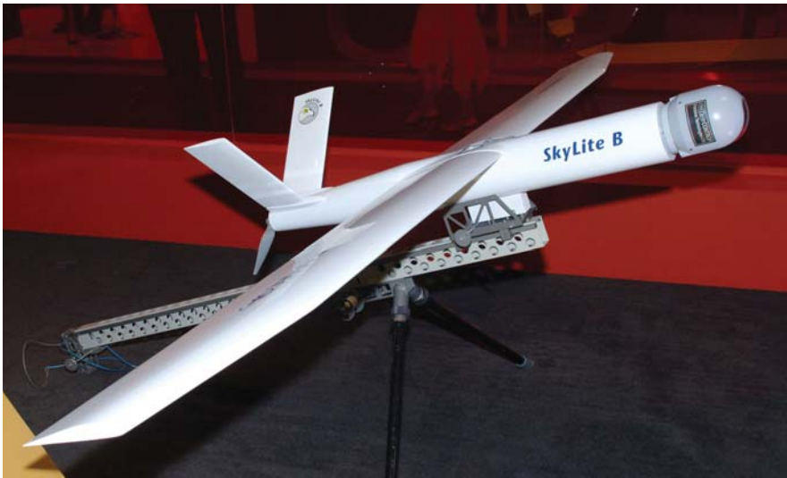
הסקיילייט B של רפאל על מתקן השיגור. בחרטומו מותקן מטעד אלקטרו-אופטי מתוצרת קונטרופ.
