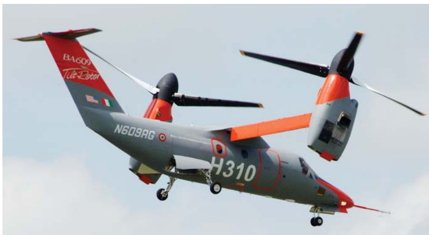
למטה: ה-BA609 ממריא אנכית. למעלה: הרוטורים בהטייה חלקית לפנים לקראת מעבר לטיסה אופקית.
