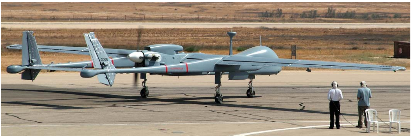
השוואה לשני האנשים מימין נותנת מושג על גודלו של ההרון TP. מוטת כנפיו היא יותר מפי 1.5 מזו של ההרון 1 הבוכנתי.
