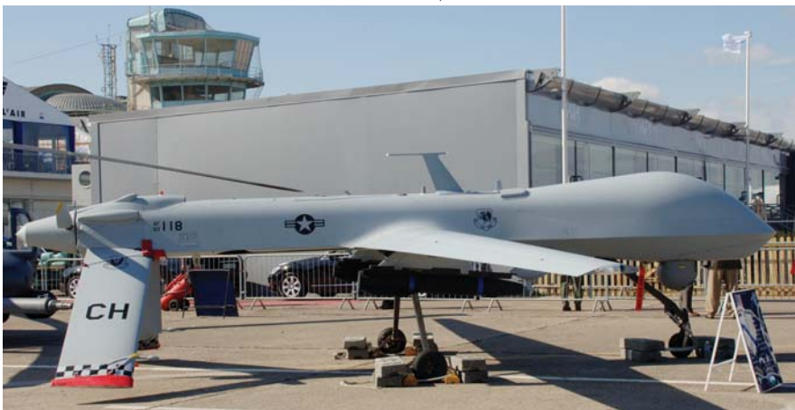
כטב"ם MQ-1 פרדטור של חיל האוויר האמריקני הנושא שני טילי הלפירי (דמה) מתחת לכנפיו.
