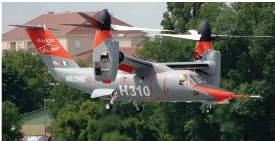
למטה: ה-BA609 ממריא אנכית. למעלה: הרוטורים בהטייה חלקית לפנים לקראת מעבר לטיסה אופקית.
