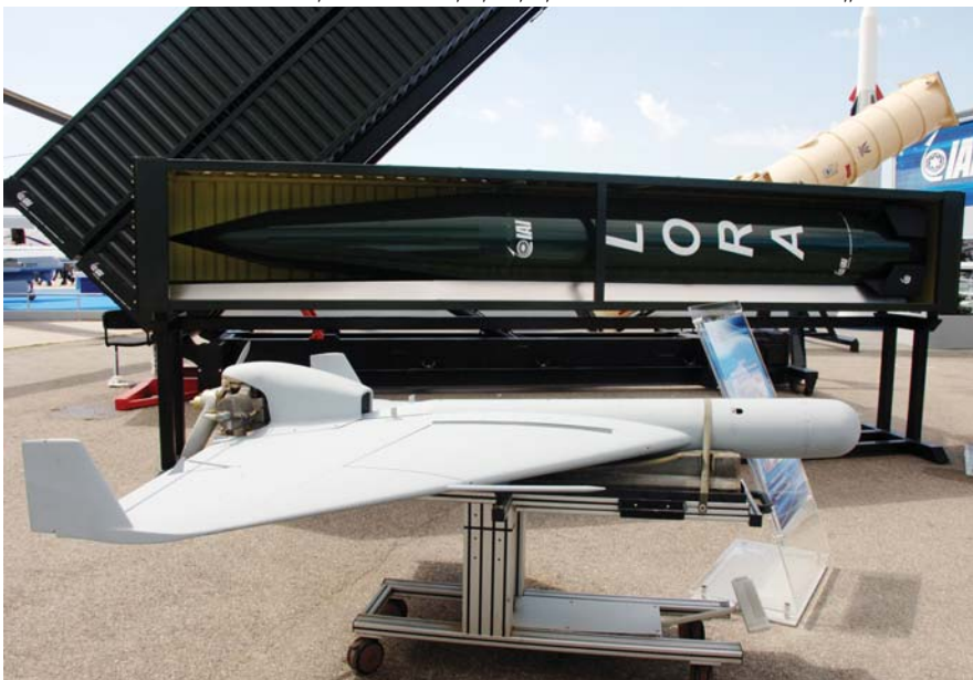
הדגם הגדול יותר I-View 250. כטב"מים אלה נוחתים באמצעות מצנח פאראפול.
