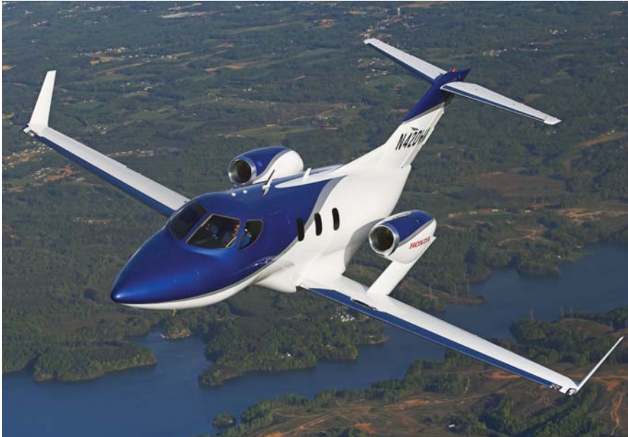
ההונדה ג'ט נבדל חימונית בהתקנת מנועיו על מנשאים גבוהים מעל לכנף.
