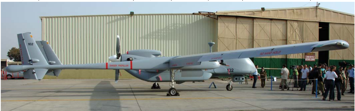
הכטב"ם הגדול איתן מתוצרת התע"א. בצילום התקריב למעלה ניתן לראות את התקנת המטעד האלקטרו-אופטי מתחת לחרטום ואת מארז הגחון המיועד למכ"ם.
