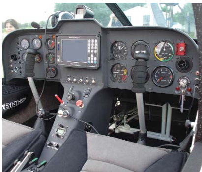
הטקסון החדש מצויד בצג צבעוני רב-תכליתי MGL Avionics מתוצרת Fly Synthesis.
