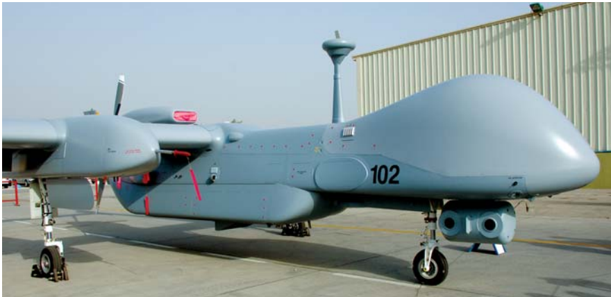
הכטב"ם הגדול איתן מתוצרת התע"א. בצילום התקריב למעלה ניתן לראות את התקנת המטעד האלקטרו-אופטי מתחת לחרטום ואת מארז הגחון המיועד למכ"ם.
