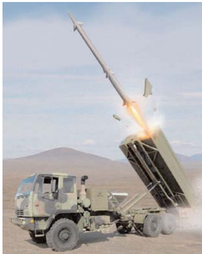
המאיץ של הטיל יפתח ויווצר בארה"ב על-ידי חברת ATK . חרטומו של הטיל מעוצב בדומה לדולפין, כדי שיוכל להכיל מספר חיישנים
