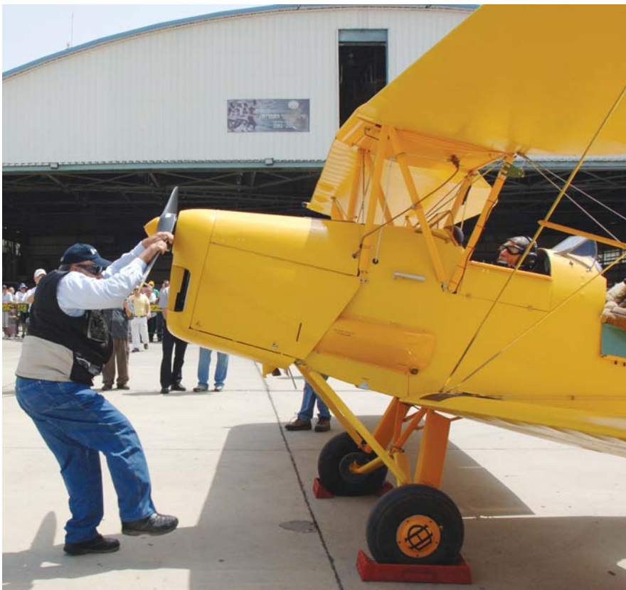
מכיוון שאין לטייגר מות' מתנע חשמלי, צריך להפעיל את המנוע על-ידי סיבוב ידני של המדחף.
