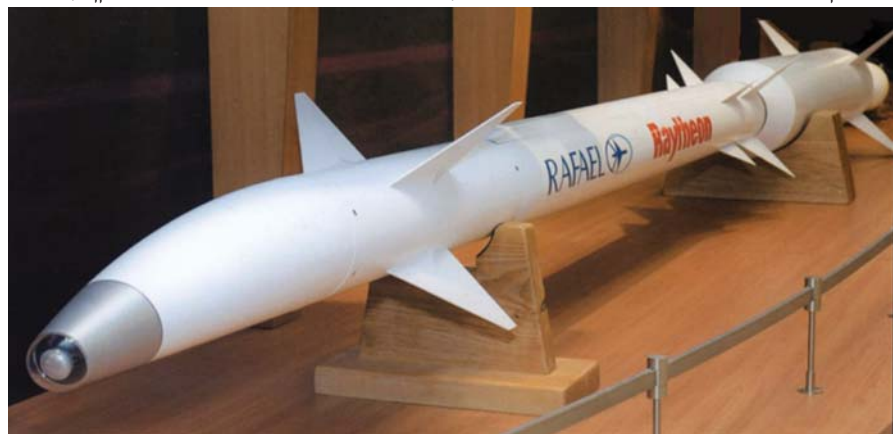
המאיץ של הטיל יפתח ויווצר בארה"ב על-ידי חברת ATK . חרטומו של הטיל מעוצב בדומה לדולפין, כדי שיוכל להכיל מספר חיישנים
