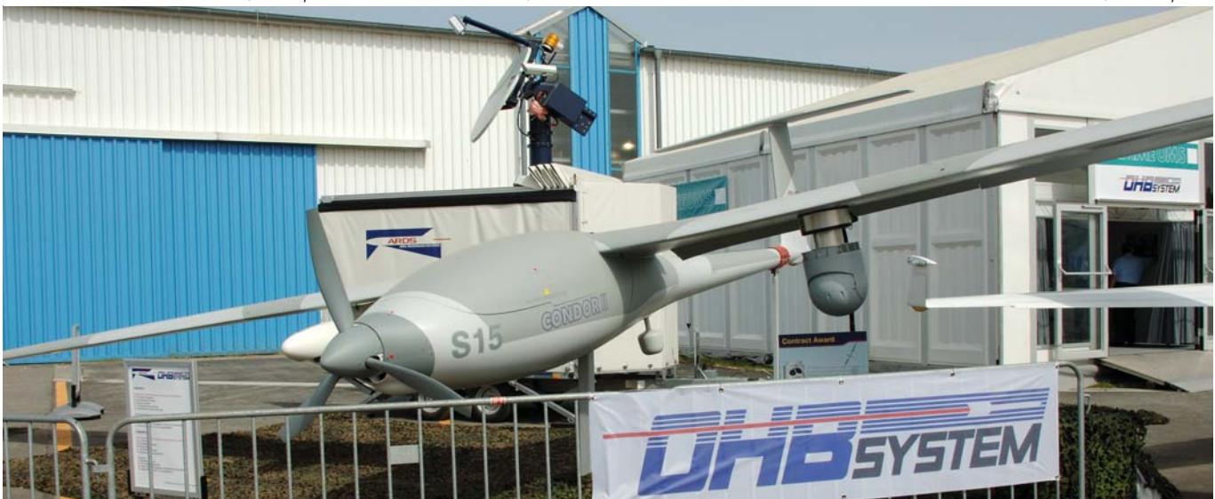
הדאון הממונע סטם S15 בגרסתו הבלתי מאוישת יכול לשמש למשימות תצפית וממסר. למעלה: הגרסה המאוישת של דאון ממונע זה.
