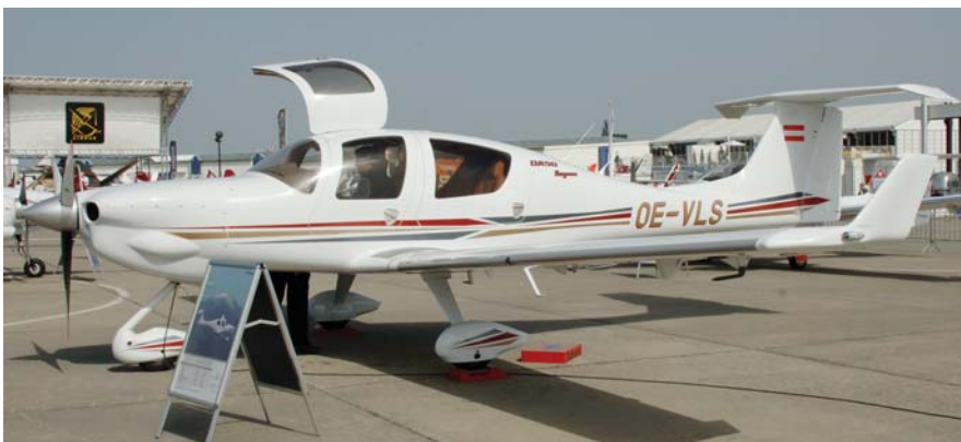
ה-DA40 סטאר (למעלה) וה-DA50 מאגנום של דיאמונד שבהם הותקן מנוע הדיזל החדש אוסטרו AE300.
