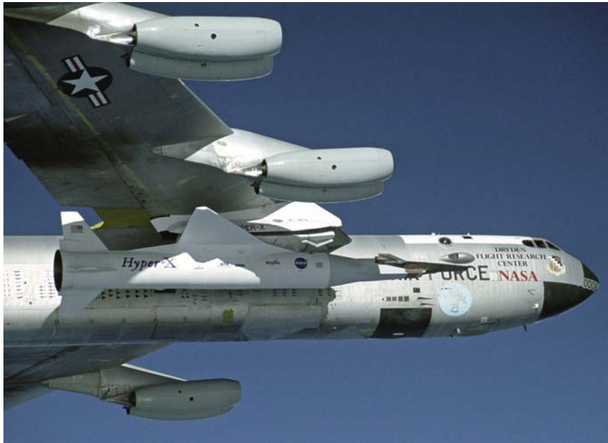
ה-X-43A המחובר למאיץ הרקטי פיגוסוס תלוי מתחת לכנף של ה-B-52B של נאס"א.
