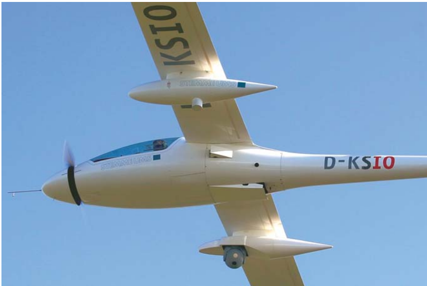
הדאון הממונע סטם S10-VTX נושא שני מארזים מתחת לכנפיו עם מערכת התצפית קונדור.
