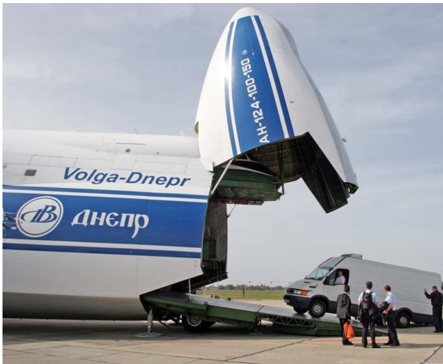
הדגמה של הסעת רכב לתוך תא המטען רחב הממדים של האנטונוב An-124 לאחר הרמת החרטום.
