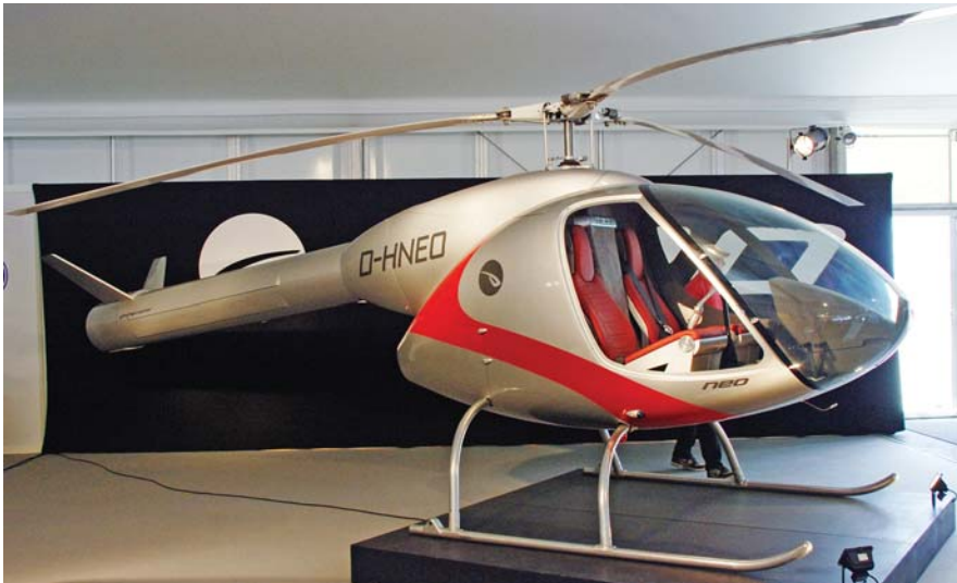
המסוק הקל Neo שיוצע כקייט לבנייה עצמית מתאפיין במערכת ייצוב ללא רוטור זנב.
