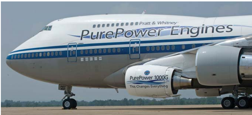
מנוע "הכוח הטהור" PW1000G הותקן על מטוס 747SP של פראט אנד ויטני לסדרה של ניסויי טיסה שנערכו ביולי-אוגוסט. למעלה: חתך המנוע, המראה את מיקום תיבת התמסורת אחרי המניפה הקדמית.
