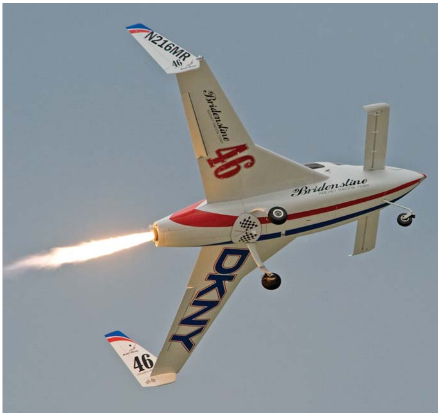
למעלה: ה-Velocity SE עם מנוע רקטי של XCOR. למטה: Velocity XL-5 עם מנוע רקטי של ארמאדילו.
