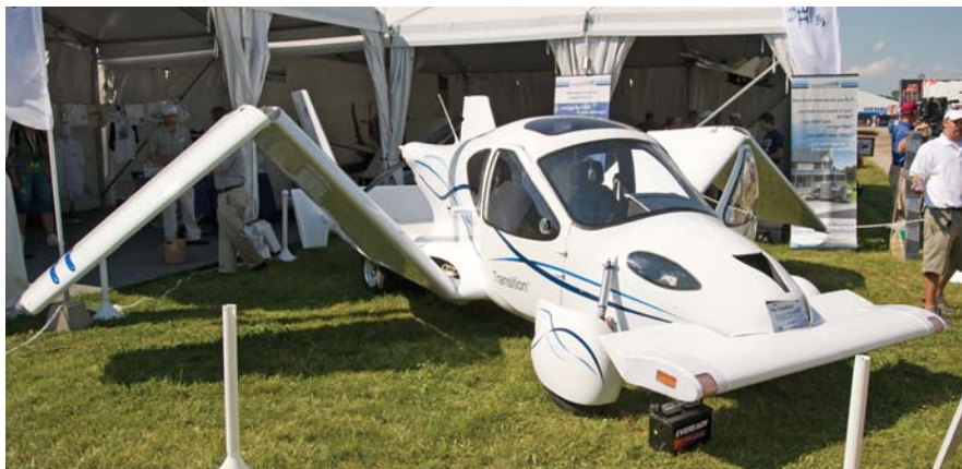
למעלה: תחילת תהליך קיפול הכנפיים. למטה: הטרנזישן עם כנפיים מקופלות, שמתאים לנסיעה בכביש.
