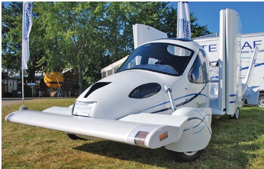
למעלה: תחילת תהליך קיפול הכנפיים. למטה: הטרנזישן עם כנפיים מקופלות, שמתאים לנסיעה בכביש.
