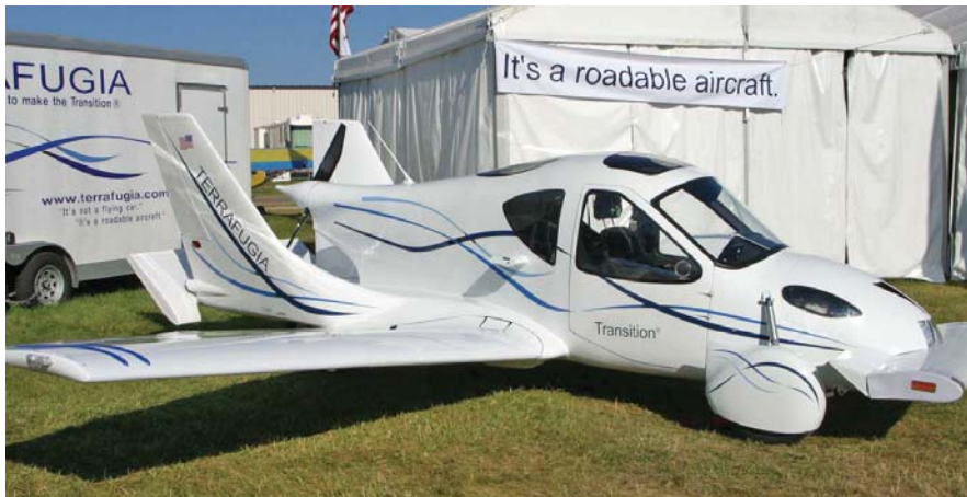
הטרנזישן של חברת טראפוגיה עם כנפיים פרושות. זהו מטוס ספורט קל המסוגל גם לנסוע בכבישים.
