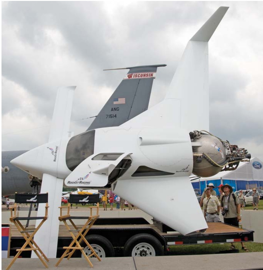
למעלה: ה-Velocity SE עם מנוע רקטי של XCOR. למטה: Velocity XL-5 עם מנוע רקטי של ארמאדילו.
