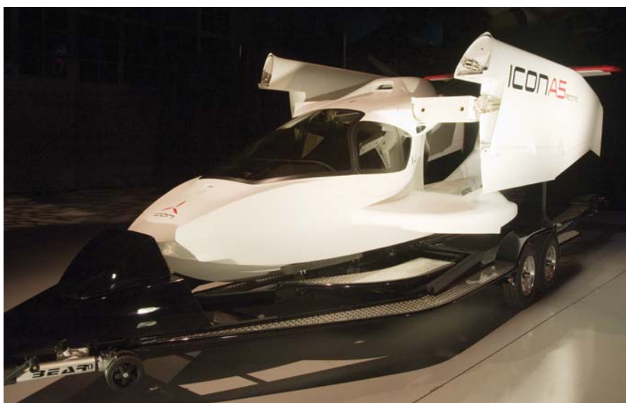
תהליך קיפול הכנפיים ב-A5 מתחיל בסיבוב הכנף כלפי מעלה. למטה: ה-A5 עם כנפיים מקופלות על נגרו.
