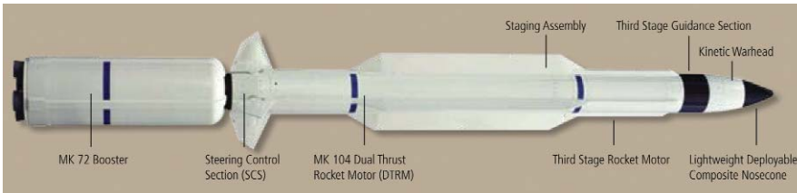
למעלה: טיל SM-3 משוגר מסיירת של צי ארה"ב. למטה: רכיבי הטיל המיועד להשמדת טילים בליסטיים.
