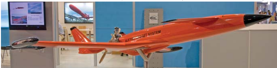
ה-Alkyon בעל מנוע הבוכנה והמדחף האחורי מיועד לאימון מפעילי תותחים נגד מטוסים.
