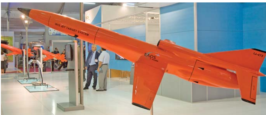
ה-Alkyon בעל מנוע הבוכנה והמדחף האחורי מיועד לאימון מפעילי תותחים נגד מטוסים.
