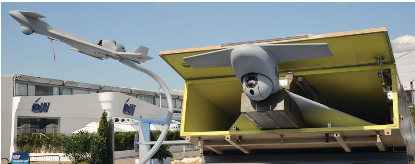
החימוש המשוטט המתקדם הרופ מאוחסן בתוך זביל מלבני שנישא על פלטפורמה ניידת ומשוגר מתוכו. משמאל ולמעלה: ההרופ בתצורת טיסה.
