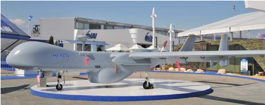
הכטב"ם הרון של התע"א נושא בגחוונו מכ"ם חיפוש ימי מתוצרת אלתא.
