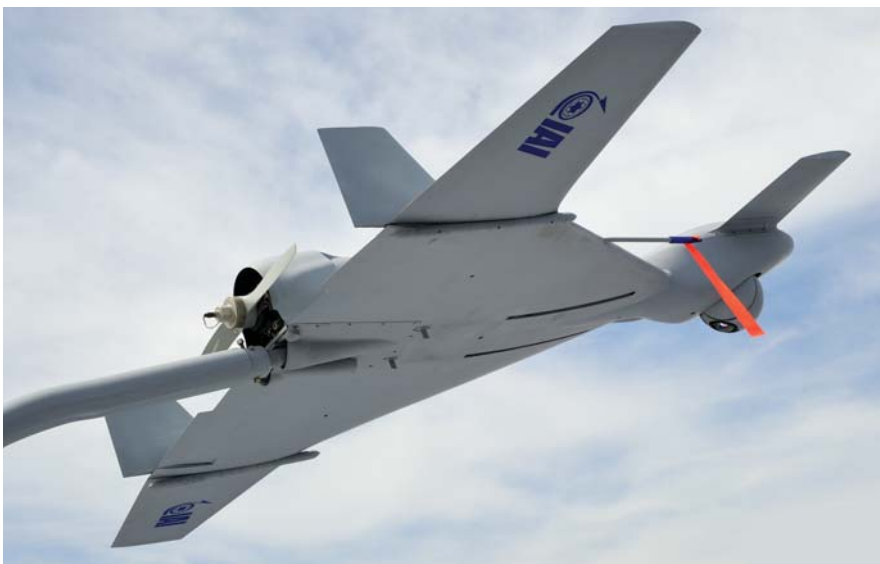
החימוש המשוטט המתקדם הרופ מאוחסן בתוך זביל מלבני שנישא על פלטפורמה ניידת ומשוגר מתוכו. משמאל ולמעלה: ההרופ בתצורת טיסה.
