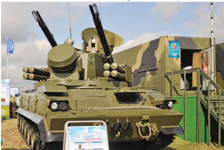
למעלה: רכב הקרב נושא המכ"ם והטילים של מערכת הני"מ TOR-M2E. למטה: מערכת הני"מ קצרת-הטווח Tunguska-M1 משלבת תותחים וטילים על רכב זחלי אחד.
