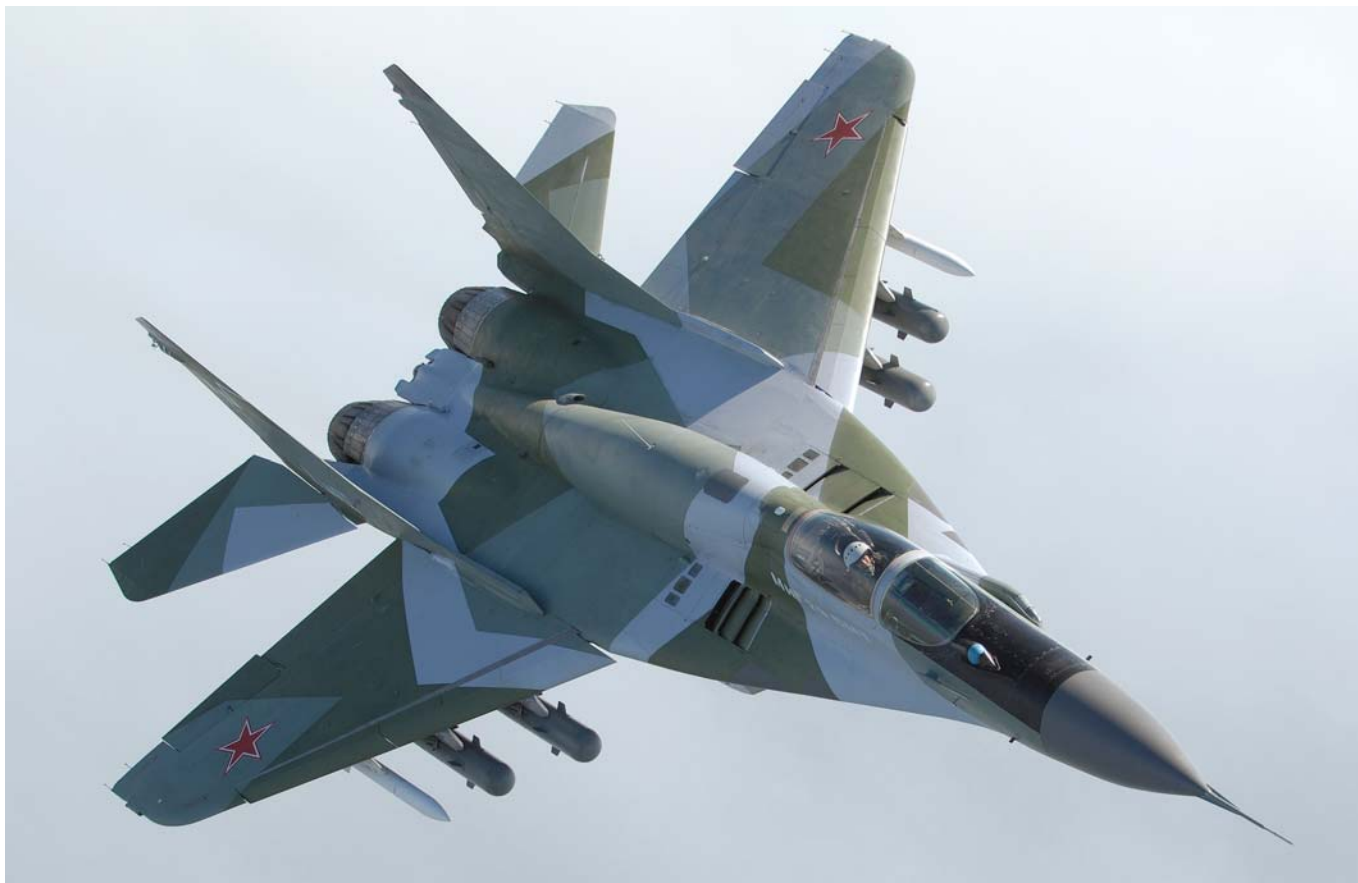
הדגם המושבח של המיג-29, המסומן MiG-29SMT, מתאפיין במערכות אוויוניקה מודרניות, מכ"ם חדש, תא טייס משודרג, יותר דלק פנימי ויכולת לתדלוק אווירי.
