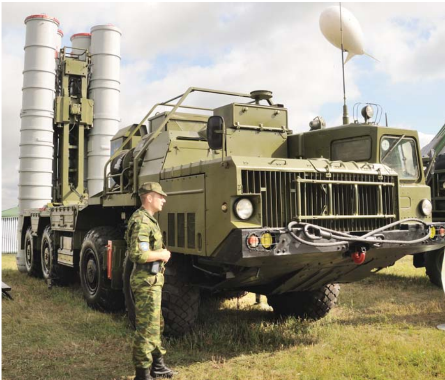
רכב הנשיאה והשיגור של טילי הקרקע-אוויר בסוללת S-300PMU2 המרכיבה את מערכת פאבוריט.
