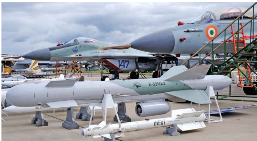
למעלה: טיל האוויר-קרקע Kh-31P , התלוי כאן בגחונו של הסוחוי Su-34 , מיועד להשמיד מכ"ם קרקעיים. למטה: טיל השיוט Kh-59MK2 מוצג כחימוש אפשרי למיג-29. לפניו נראה טיל האוויר-אוויר R-73E .
