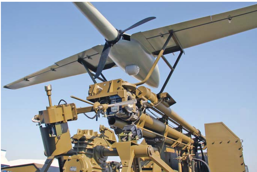
הכטב"ם UAV-08 של חברת לוטץ' על רכב השיגור (למטה). שים לב להתקנה המיוחדת של המדחף (למעלה).
