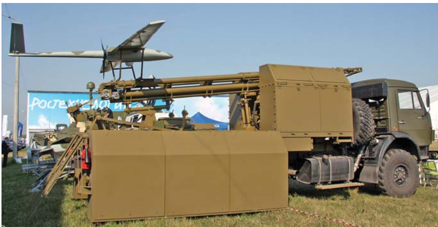
הכטב"ם UAV-07 של לוטץ' בעל תצורת הקנארד על מעוט קרקעי. עמדת הבקרה נמצאת ברכב שלידו.
