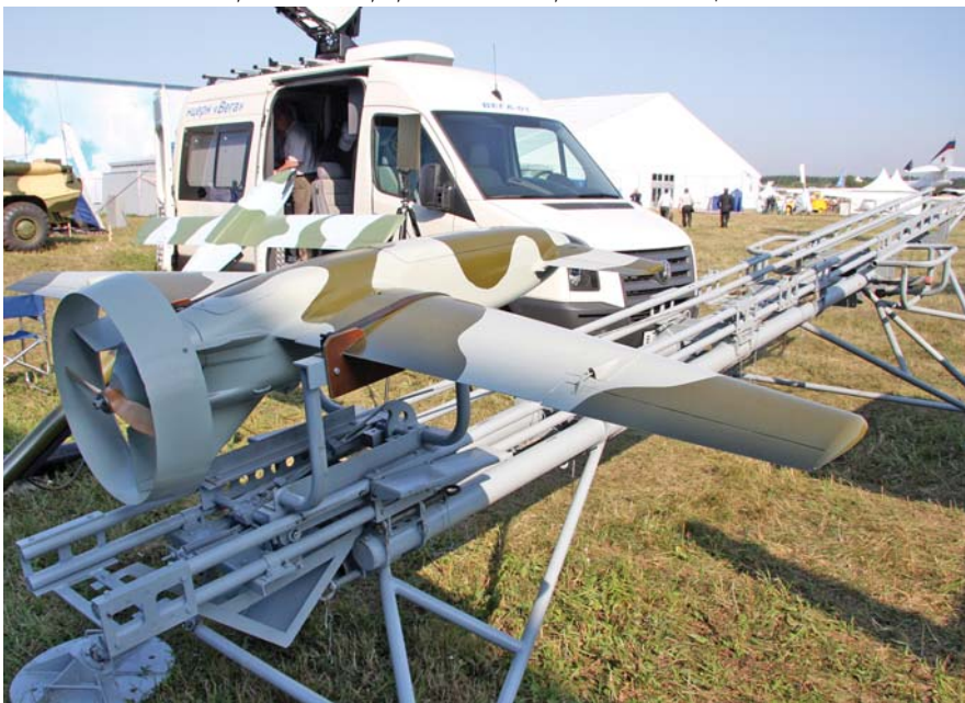
הכטב"ם UAV-07 של לוטץ' בעל תצורת הקנארד על מעוט קרקעי. עמדת הבקרה נמצאת ברכב שלידו.
