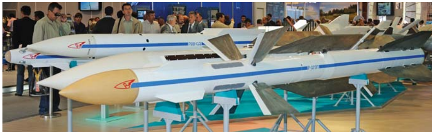
טיל האוויר-אוויר היחודי R-27EP מתבית על קרינת המכ"ם של מטוס האויב.
