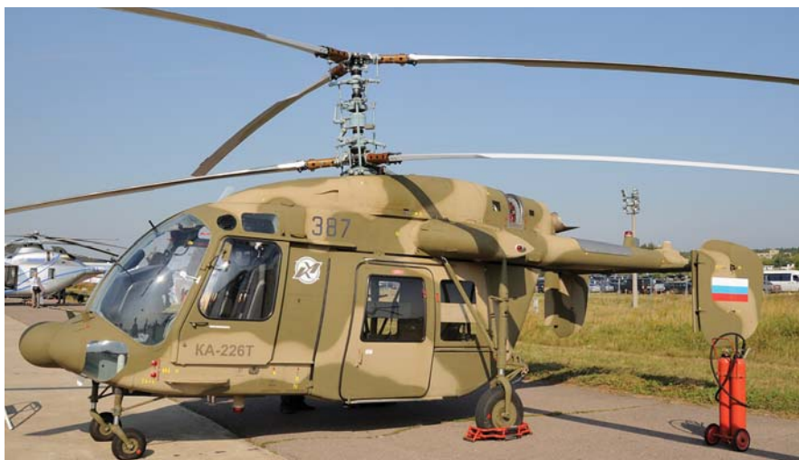
המסוק הקל Ka-226T מצויד בזוג מנועי טורבינה צרפתיים מדגם טורבומקה אריס 2G2. דגם מוקטן של מטוס הנוסעים העתידי MC-21 בביתן של חברת המטוסים המאוחדת.
