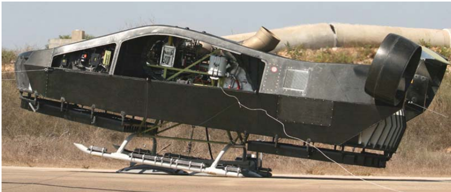
אב-הטיפוס של הפרד בניסויים קרקעיים. למטה: מבטי על וצד של הכטב"ם הייחודי.
