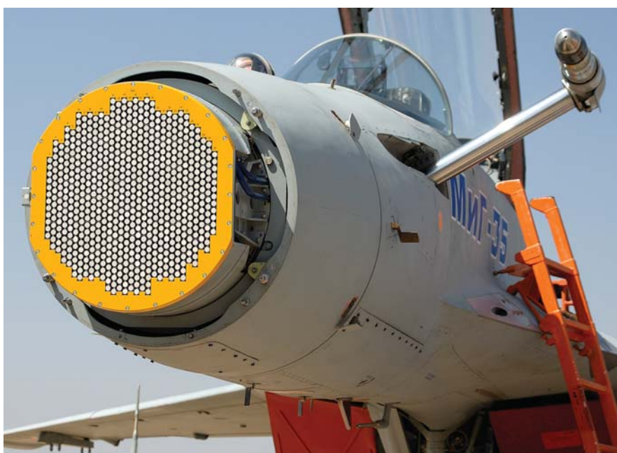
במיג-35 מותקן מכ"ם מערך מופע אקטיבי Zhuk-AE. שים לב לחדק התדלוק הנשלף מהגוף.
