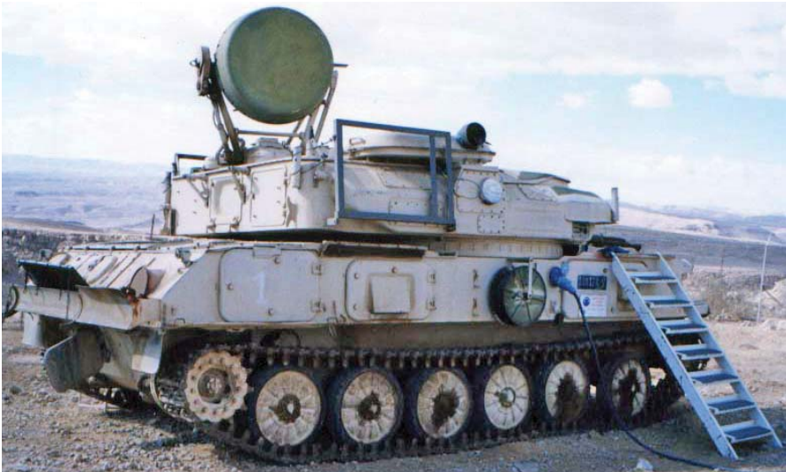
מכ"ם הסקירה של מערכת SA-8 במצב פרוס על הרכב מאחור. מכ"ם העקיבה נמצא בקדמת הרכב.
