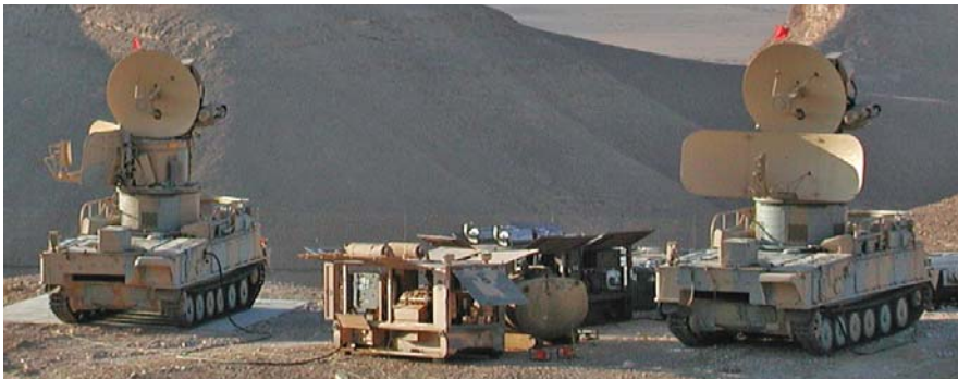
למעלה ולמטה: מכ"מי הסקירה והעקיבה (Straight Flush בקוד נאט"ו) של מערכת SA-6, הנישאים על רכב זחלי.
