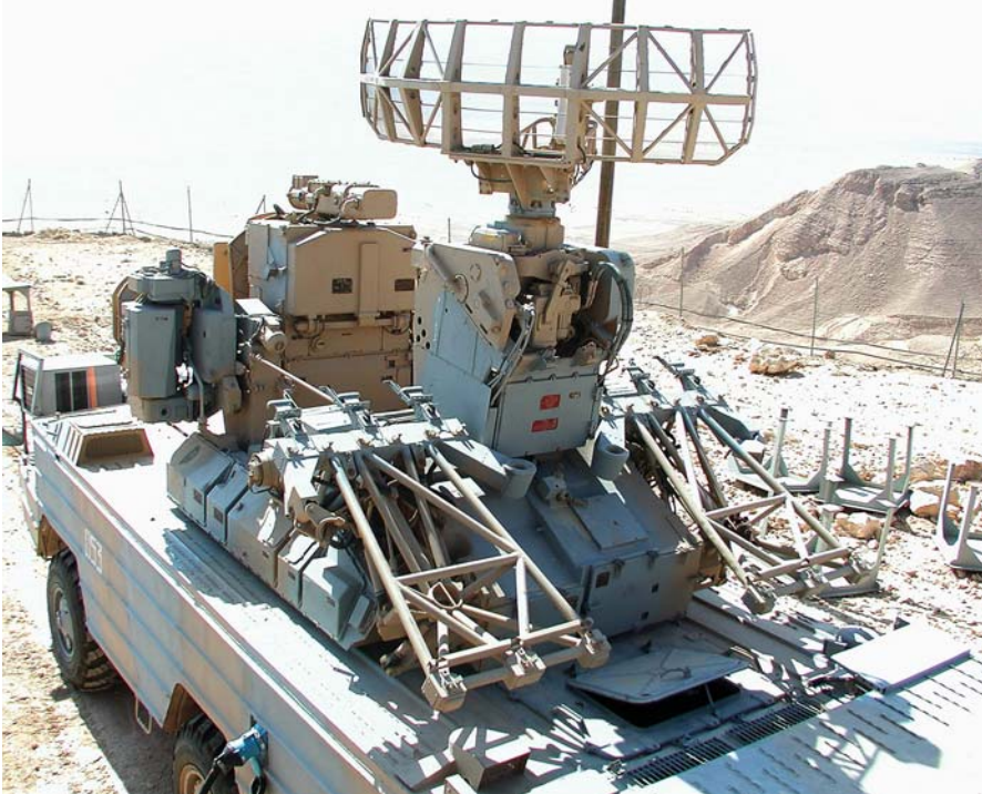
מכ"ם הסקירה של מערכת SA-8 במצב פרוס על הרכב מאחור. מכ"ם העקיבה נמצא בקדמת הרכב.
