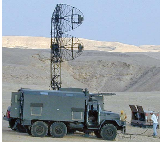
מכ"ם החיפוש P-19 (Flat Face B בקוד נאט"ו) משרת סוללות SA-3.
