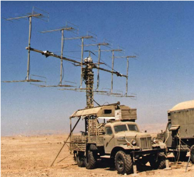
מכ"ם החיפוש P-12 משמש לרכישת מטרות עבור סוללות SA-2.
