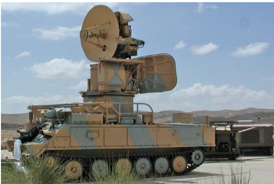
למעלה ולמטה: מכ"מי הסקירה והעקיבה (Straight Flush בקוד נאט"ו) של מערכת SA-6, הנישאים על רכב זחלי.
