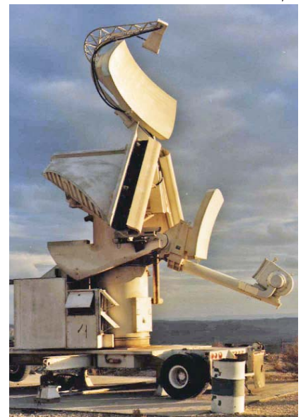
מכ"ם בקרת-האש של מערכת SA-3, המכונה בקוד נאט"ו Low Blow.
