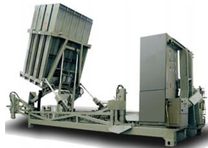
למעלה: המקטע הקדמי של הטיל המיירט תמיר של כיפת ברזל . למטה: המשגר המכיל 20 טילים.
