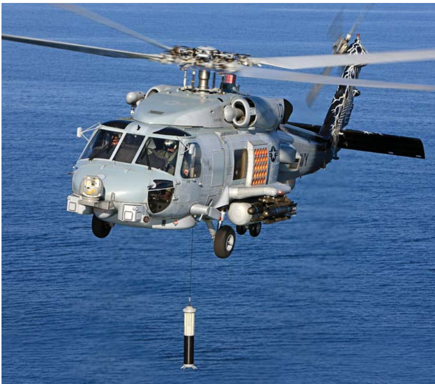
למעלה: המסוק הימי סיקורסקי MH-60R סיהוק של צי ארה"ב מוריד את הסונאר לתוך המים כדי לגלות צוללות. למטה: המסוק מדגם זה שהוצג בפארובורו.
