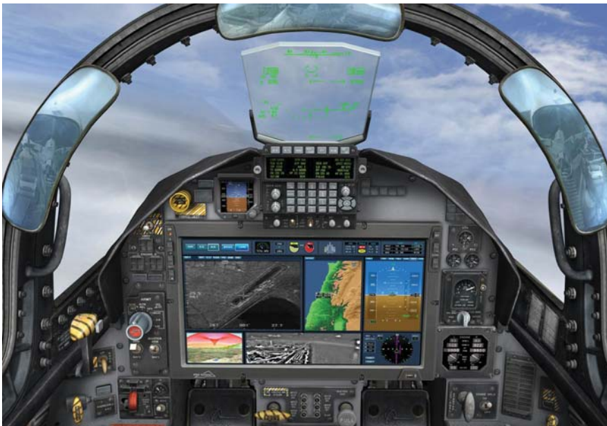
מסך הנגיעה המרכזי למטוסי קרב שמוצע על-ידי אלביט מערכות במסגרת CockpitNG .
