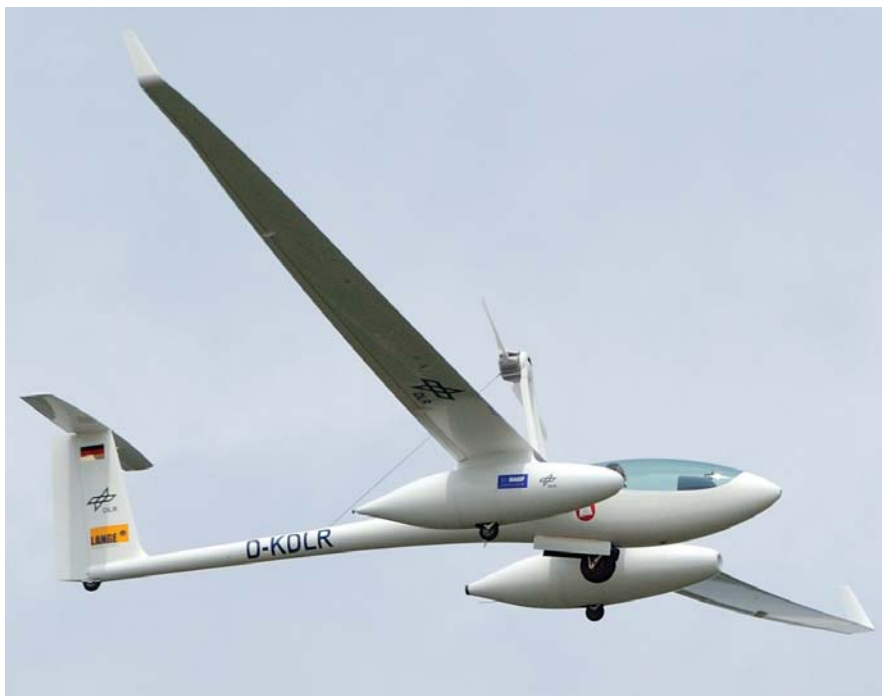
הדאון הממונע Antares DLR-H2 טס עם מערכת הנעה חשמלית המבוססת על תאי דלק המוזנים במימן.
