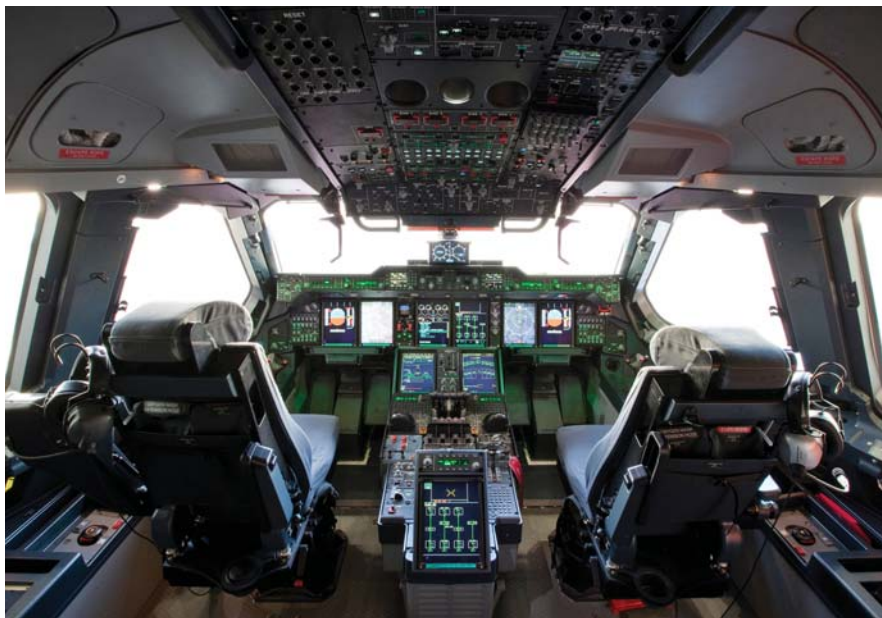
תא הטייסים המודרני של ה-A400M מתאפיין בשמונה צגים דיגיטליים צבעוניים ושתי תצוגות עליות.
