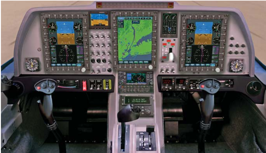
תא הטייסים המודרני עם שלושה צגים דיגיטליים צבעוניים גדולים, שמתקנה אלביט מערכות ב-G120TP.
