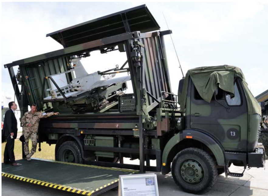
למעלה: הכטב"ם KZO מוזנק ממשגר הנישא על משאית. למטה: הדגם החדש שלו עם מטע"ד משופר.
