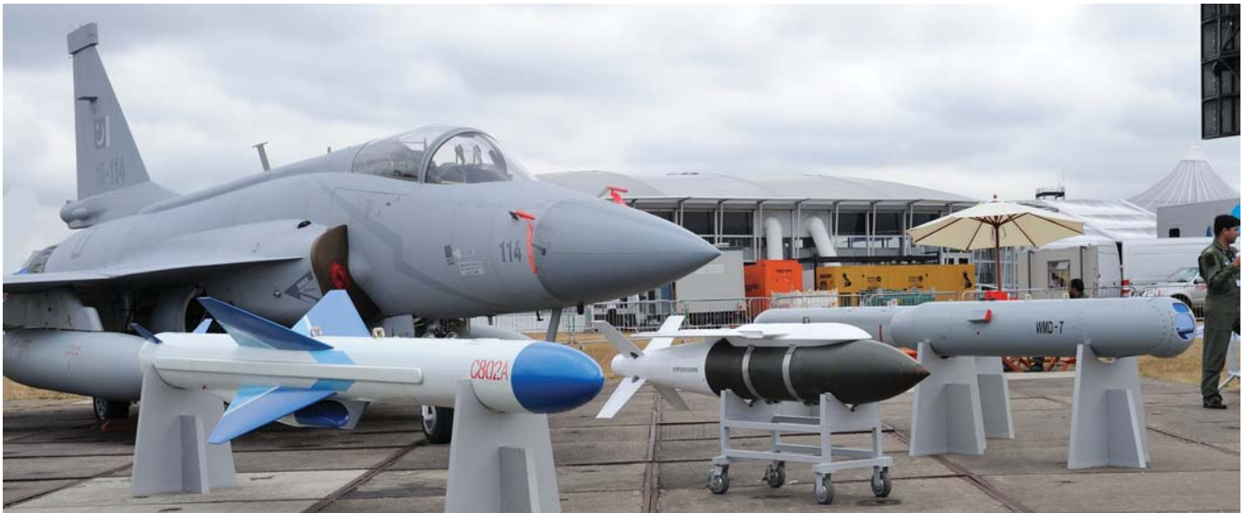
מטענים חיצוניים שניתנים לנשיאה על ה-JF-17: הטיל נגד ספינות C-802A (משמאל), הפצצה הגולשת LS-6 במשקל 500 ק"ג, והמארז האלקטרו-אופטי WMD-7.
