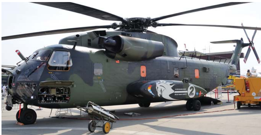
למטה: מסוק ה-CH-53GA השני שהושב על-ידי חברת יורוקופטר. למעלה: תא הטייסים החדש שלו.
