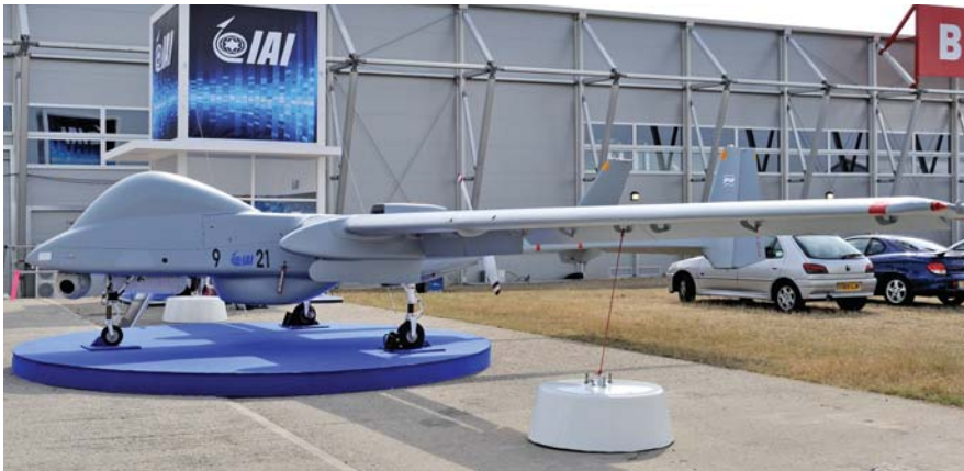
הכטב"ם הרון 1 של התע"א בתצורה עם מטע"ד אלקטרו-אופטי, מכ"ם SAR ואנטנה לתקשורת לוויינית.
