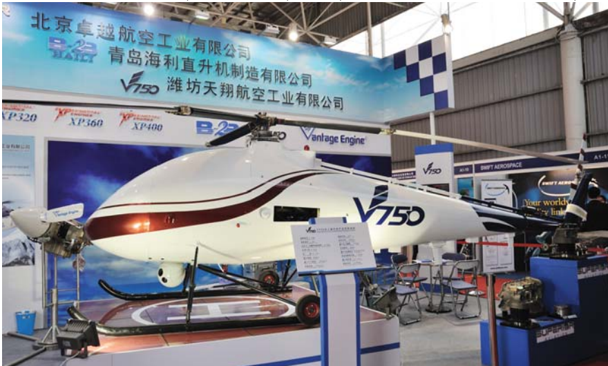
המסוק הבלתי מאויש V750 מבוסס על המסוק האמריקני הדור-מושבי הקל ברנטלי B-2B.
