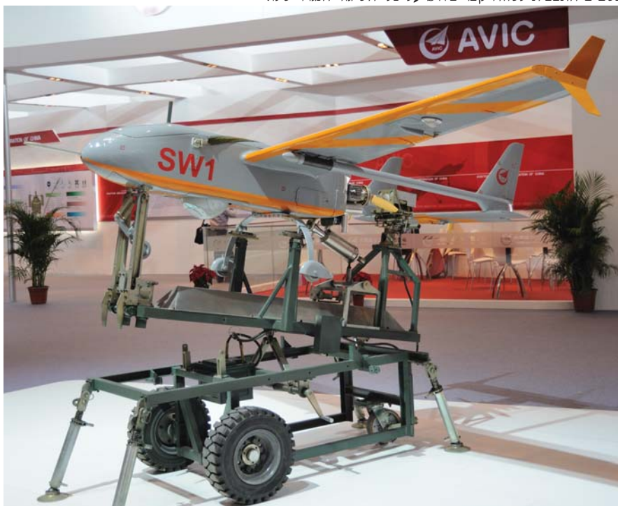
כטב"ם התצפית לטווח קצר SW1 על כלי השיגור הנגרר שלו.
