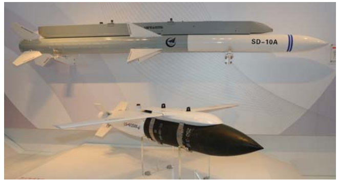
למעלה: טיל אוויר-אוויר לטווח בינוני SD-10A, בעל הנחיית מכ"ם אקטיבית. למטה: פצצה גולשת LS-6 במשקל 570 ק"ג עם הנחיה משולבת אינרציאלית ו-GPS, היכולה להגיע עד לטווח של 60 ק"מ בשיגור מגובה רב.
