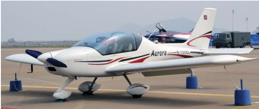
מטוס הספורט הקל אורורה מתוצרת Sunward Tech בנוי כולו מחומרים מרוכבים.
