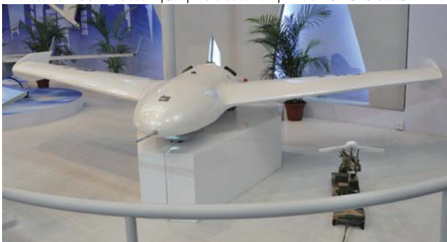
ה-SH-1 של CASIC מתאפיין בתצורה של כנף וגוף משולבים ללא משטחי זנב.
