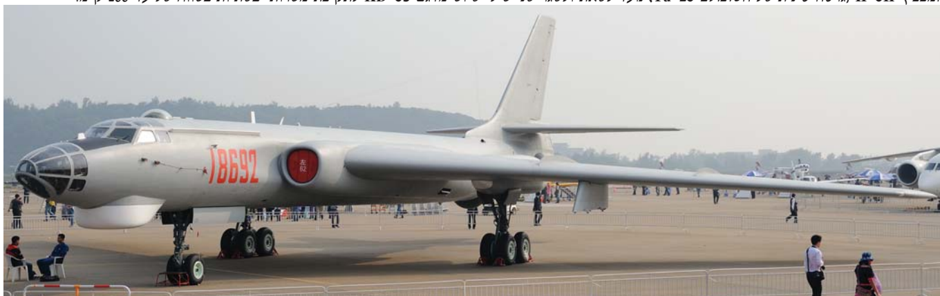
המפציץ H-6H (גרסה סינית של הטופולב Tu-16) נועד לשאת ולשגר שני טילי שיוט מדגם KD-63 לתקיפת מטרות יבשתיות בטווח של עד 200 ק"מ.
