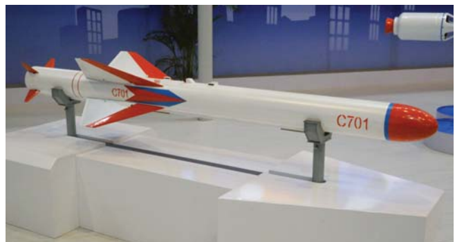
ה-C701 נועד לפגוע בספינות קטנות יחסית בטווח של עד 15 ק"מ בלבד. משקלו 100 ק"ג והוא נושא ראש קרבי בן 29 ק"ג. שיטת ההנחיה היא טלוויזיונית.
