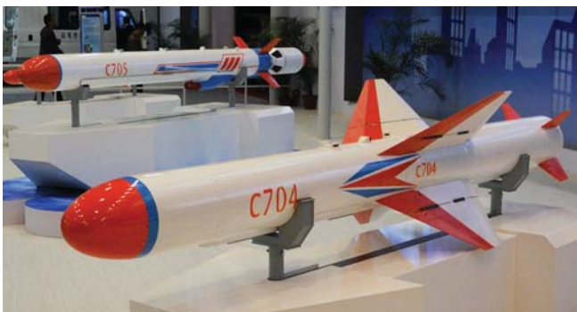
ה-C704 הוא גרסה מוגדלת של ה-C701, שמיועד לפעול בטווח של עד 35 ק"מ ומצויד בראש ביות מכ"ם. מאחוריו נראה ה-C705 הגדול עוד יותר, שיכול להגיע לטווח של 170 ק"מ עם המאיץ הרקטי שמוצמד לו מאחור.
