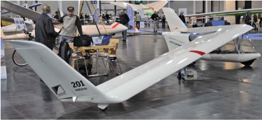
גלשן האוויר הממונע סוויפט-לייט E בעל תא הטייס הסגור, שמצויד במנוע חשמלי.
