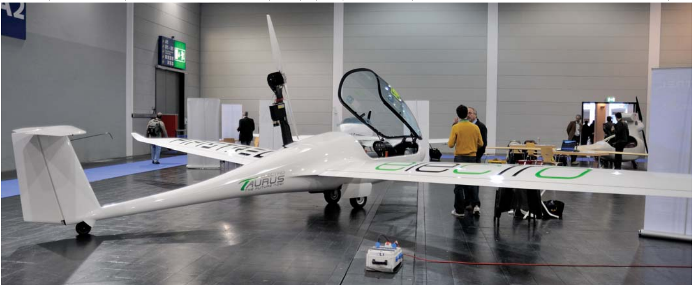
הדאון הדו-מושבי טאורוס אלקטרו שמצויד במנוע חשמלי. המדחף הדו-להבי נשלף מתוך גוף הדאון. למעלה: הנגרי הסולארי שמטעין את מצברי הדאון.
