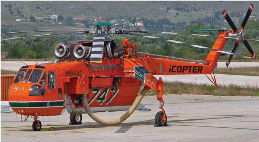
מסוק אריקסון S-64E הנושא מכל בעל קיבול של 10,000 ליטר. הצינור הגדול משמש לשאיבת מים.
