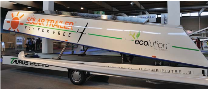
הדאון הדו-מושבי טאורוס אלקטרו שמצויד במנוע חשמלי. המדחף הדו-להבי נשלף מתוך גוף הדאון. למעלה: הנגרי הסולארי שמטעין את מצברי הדאון.
