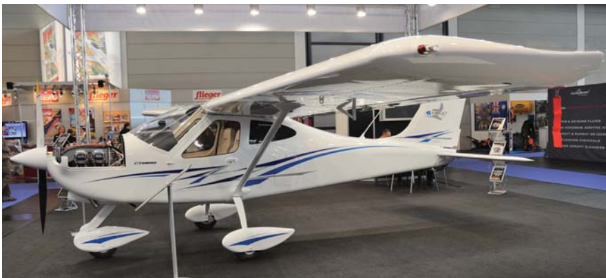
מטוס הספורט הקל P92 Eaglet G5-LY המצויד במנוע לייקומינג בן 115 כ"ס. המטוס הרב-משימתי (MMA) של טכנאם , המצויד במערכות של Airborne Technologies .
