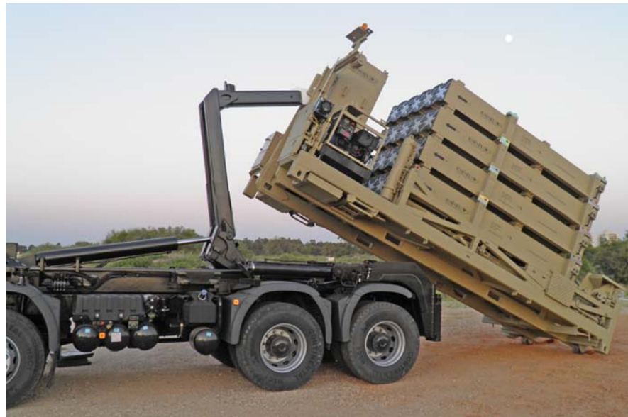
למעלה: פריקת יחידת המשגר מהמשאית הנושאת. למטה: המשגר של כיפת ברזל פרוס בשטח ומוכן לירי.
