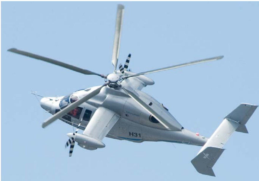
למעלה ולמטה: המסוק הניסיוני X 3 משלב רוטור ראשי רגיל עם שני מדחפים המונעים בתמסורת מהמנוע.
