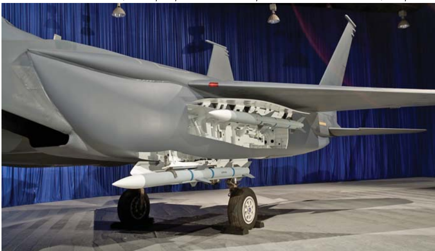
מבט מקרוב על נשיאת טיל אוויר-אוויר בתוך תא החימוש הדפון לגוף שמיועד ל-F-15SE.
