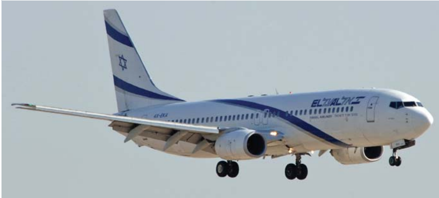
הבואינג 737-800 של אל-על שרישומו 4X-EKA צויד בחודש אוקטובר בכנפוני קצות-כנף (למעלה), התורמים לחיסכון בתצרוכת הדלק. אותו מטוס נראה למטה בתצורתו המקורית, כפי שצילמנו בשנת 2006.
