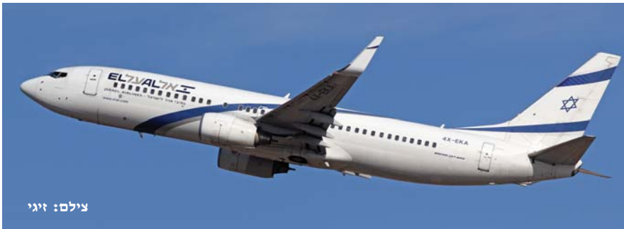
הבואינג 737-800 של אל-על שרישומו 4X-EKA צויד בחודש אוקטובר בכנפוני קצות-כנף (למעלה), התורמים לחיסכון בתצרוכת הדלק. אותו מטוס נראה למטה בתצורתו המקורית, כפי שצילמנו בשנת 2006.
