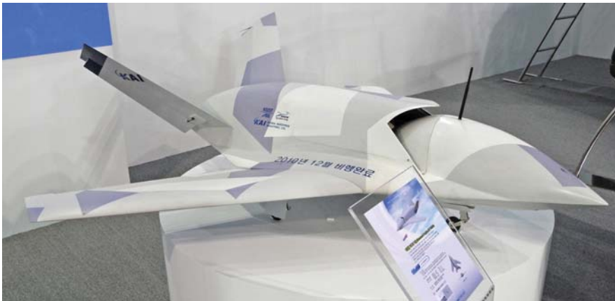
הכטב"ם KUS-9 שפותח על-ידי קוריאן אייר מתאפיין בגוף וכנפיים משולבים.
