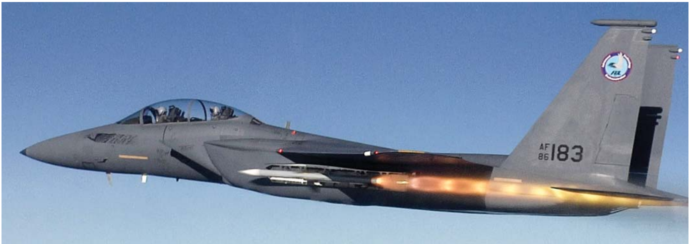
שיגור טיל אוויר-אוויר AIM-120 מתא נשיאת חימוש דפון לגוף שהותקן לניסיון במטוס F-15E שמדגים את הפתרונות המיועדים לנשר השקט.
