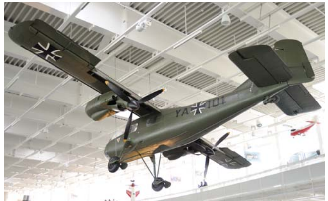
Do-29 : מטוס ניסיוני לבדיקת רעיון המראה ונחיתה קצרה על-ידי הטיית המדחפים האחוריים כלפי מטה. טס לראשונה בדצמבר 1958.
