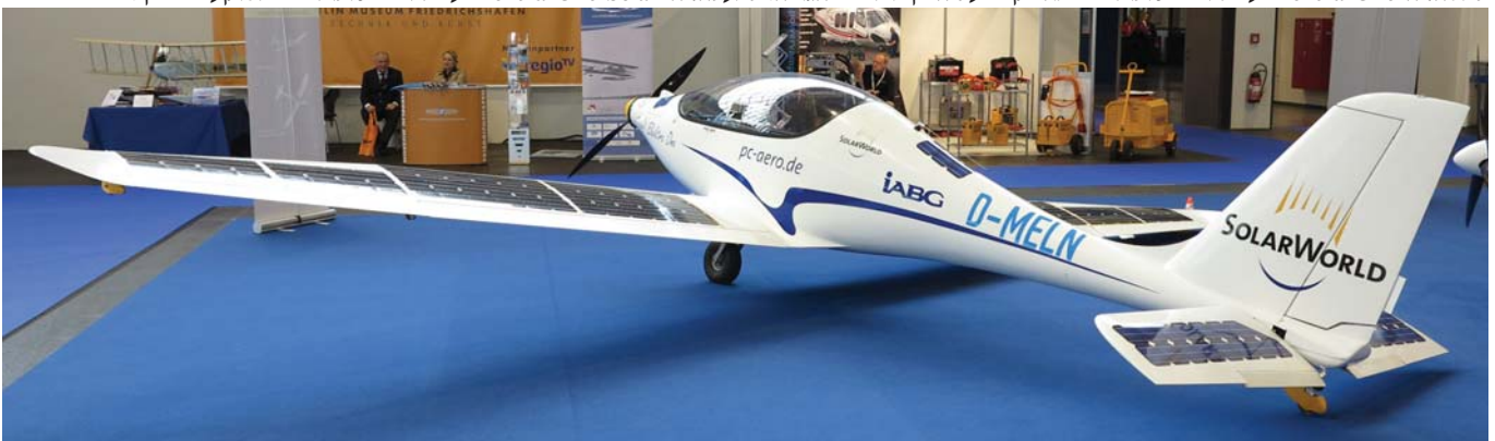
למטה: ה-Eleetra One עם תאים סולאריים מודבקים על הכנף ומייצב הגובה. למעלה: ה-Eleetra One Solar עם תאים סולאריים משוקעים בכנף.
