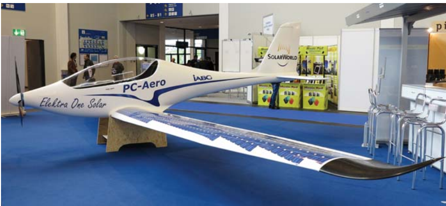
למטה: ה-Eleetra One עם תאים סולאריים מודבקים על הכנף ומייצב הגובה. למעלה: ה-Eleetra One Solar עם תאים סולאריים משוקעים בכנף.
