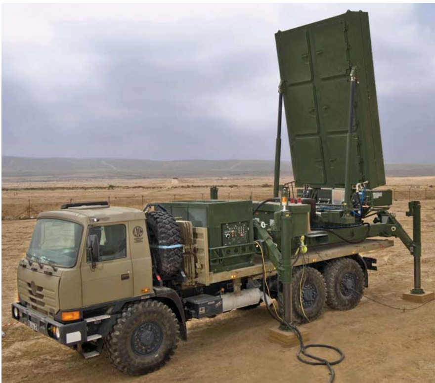
למטה: מכ"ם מדגם EL/M-2084 מתוצרת אלתא מערכות נישא על גבי משאית צבאית. למעלה: תמונת צג המחשב בניסוי שיגור של שני מיירטים נגד שתי מטרות, כאשר מטרה שלישית נופלת מחוץ לאזור המוגן.
