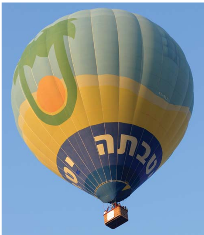
הכדור הפורח מדגם אולטראמג'יק M-160 שרישומו 4X-BLZ מופעל גם הוא על-ידי חברת Over Israel . עם מעטפת בנפח 4,550 מ"ק הוא יכול להטיס שמונה נוסעים.
