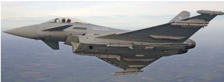
יורופייטר טייפון של חיל האוויר המלכותי הבריטי נושא זוג טילי מטאור מתחת לכונסי האוויר.
