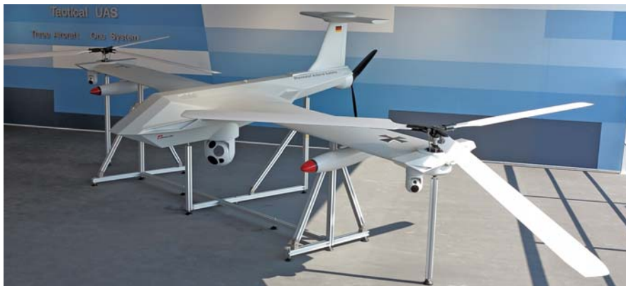
הכטב"ם הטקטי TU-150 מסוגל להמריא ולנחות אנכית, וגם לרחף, באמצעות רוטורים המותקנים בקצות הכנף. למטה: הכטב"ם הטקטי TR-50.
