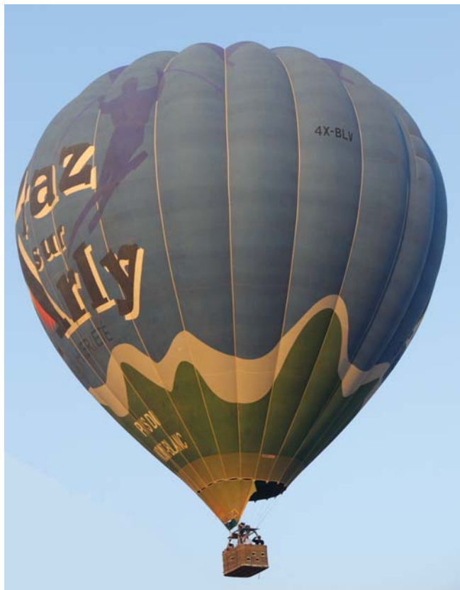
חברת לגעת בשמיים מפעילה בארץ גם כדור פורח מסוג קמרון A210, בעל מעטפת בנפח 5,950 מ"ק, שרישמו 4X-BLV. הוא נושא סל המחולק לחמישה תאים – אחד מרכזי לטייס וארבעה לנוסעים. הקיבולת היא עד 10 נוסעים.
