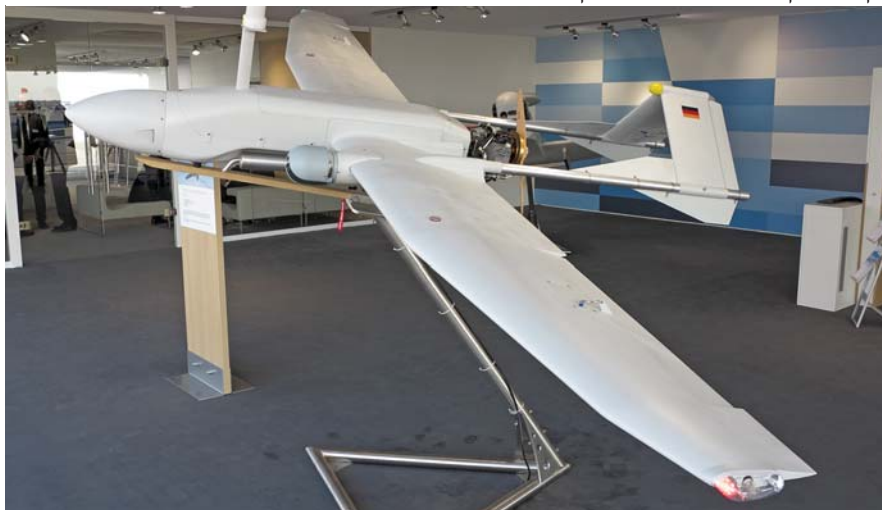
הכטב"ם הטקטי TU-150 מסוגל להמריא ולנחות אנכית, וגם לרחף, באמצעות רוטורים המותקנים בקצות הכנף. למטה: הכטב"ם הטקטי TR-50.
