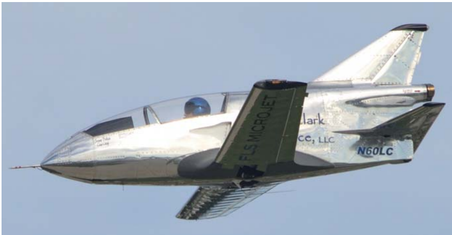
למעלה: ה-BD-5FLS מיקרוג'ט של ג'אסטין לואיס. למטה: אב-הטיפוס של הסאבסונקס. לשני המטוסים אותו מנוע סילון מסוג TJ100, המפתח דחף מרבי של 120 ק"ג-כוח.
