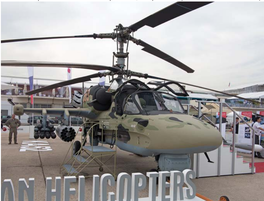
הקאמוב Ka-52 יכול לשאת מגוון טילים ורקטות על שלוש נקודות תלייה חיצוניות בכל כנף.
