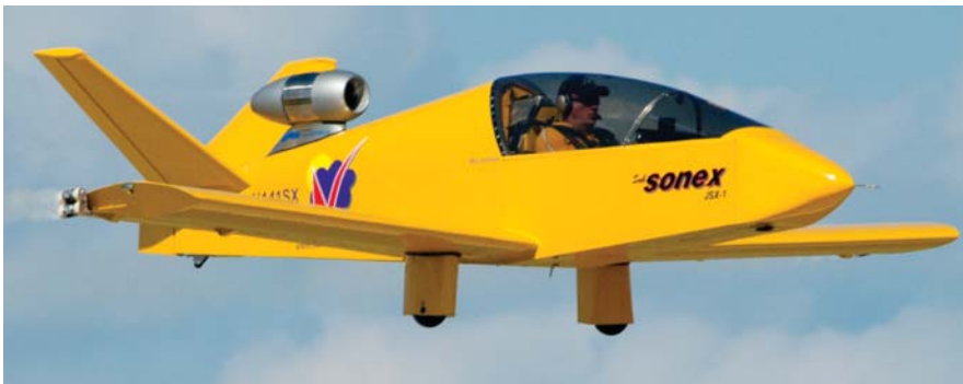
למעלה: ה-BD-5FLS מיקרוג'ט של ג'אסטין לואיס. למטה: אב-הטיפוס של הסאבסונקס. לשני המטוסים אותו מנוע סילון מסוג TJ100, המפתח דחף מרבי של 120 ק"ג-כוח.
