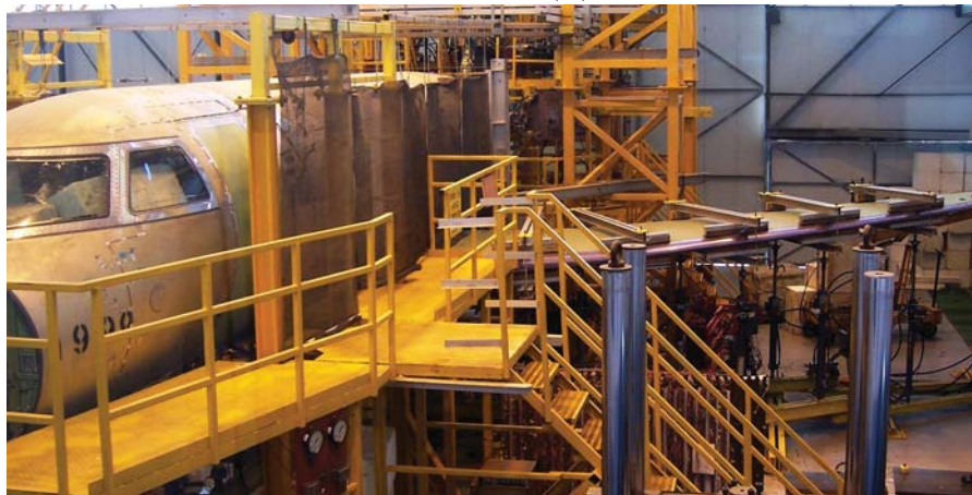
ניסוי התעייפות שמבוצע במעבדות ניסויי קרקע בתע"א על מטוס המנהלים הסילוני G280.
