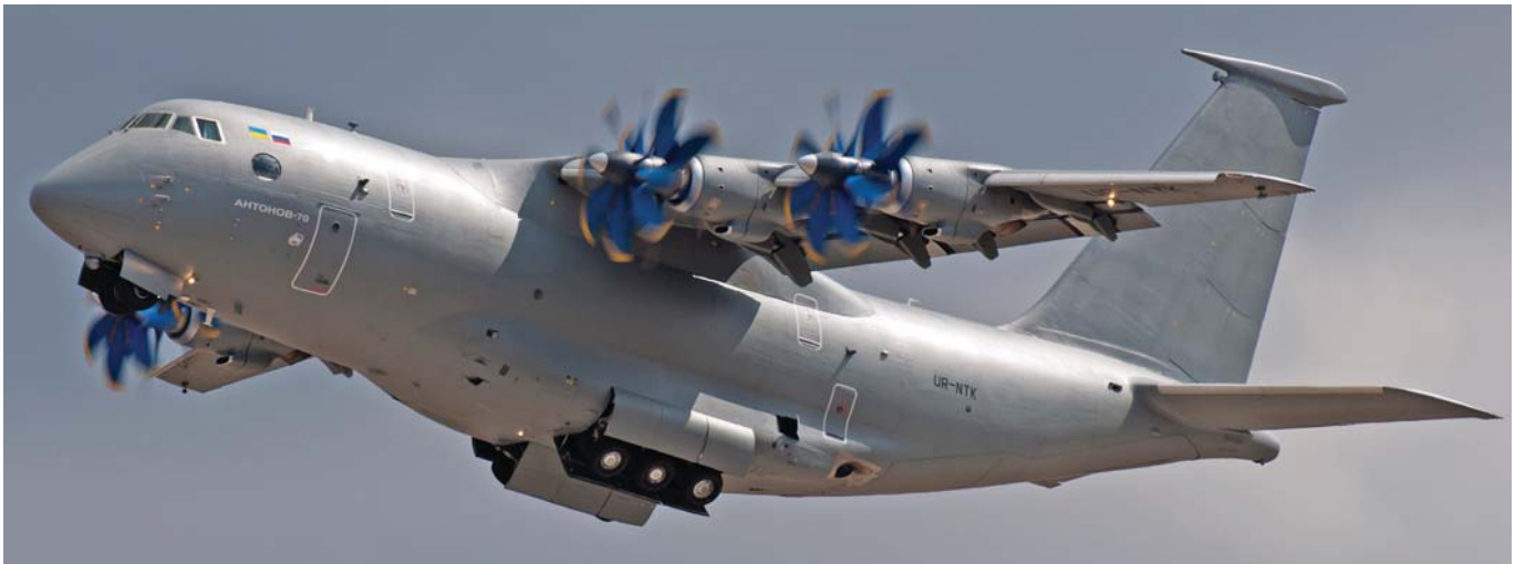
מנועי הטורבינה של האנטונוב An-70 מסובבים זוג מדחפי מניפה בעלי שמונה להבים, שמורכבים האחד מאחורי השני ומסתובבים בכיוונים מנוגדים.
