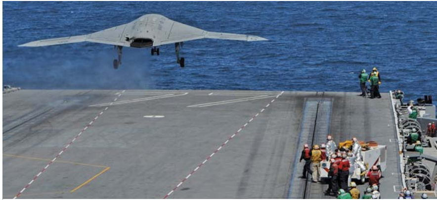
למעלה ולמטה: ה-X-47B מוזק מספון נושאת המטוסים CVN-77 ג'ורג' בוש של צי ארה"ב.
