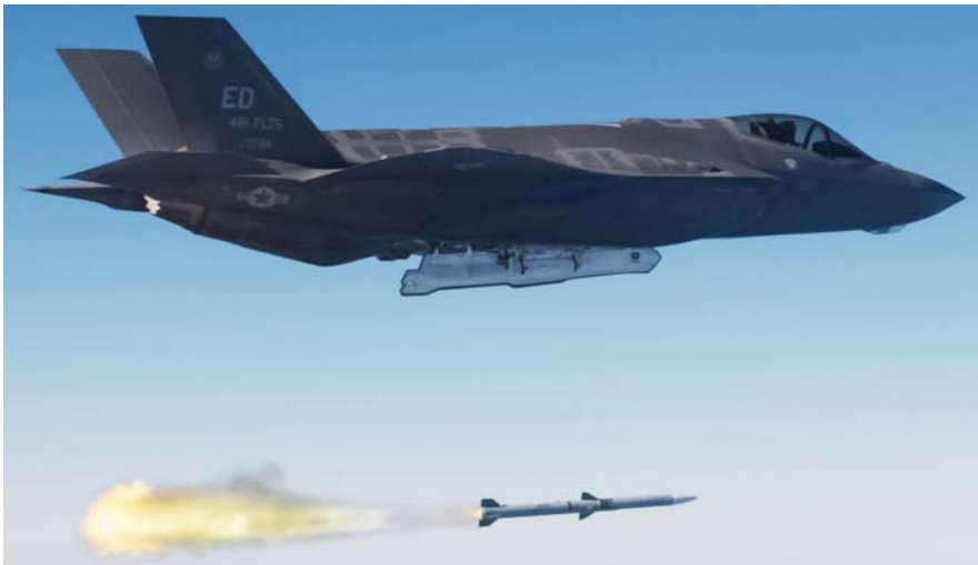
F-35A של חיל האוויר האמריקני משגר טיל אוויר-אוויר AIM-120 מתוך תא החימוש הפנימי בגחון.
