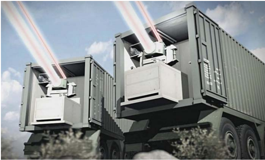
שני הלייזרים של מערכת קרן ברזל פועלים מתוך משאית. מדובר בלייזר מצב מוצק חשמלי.
