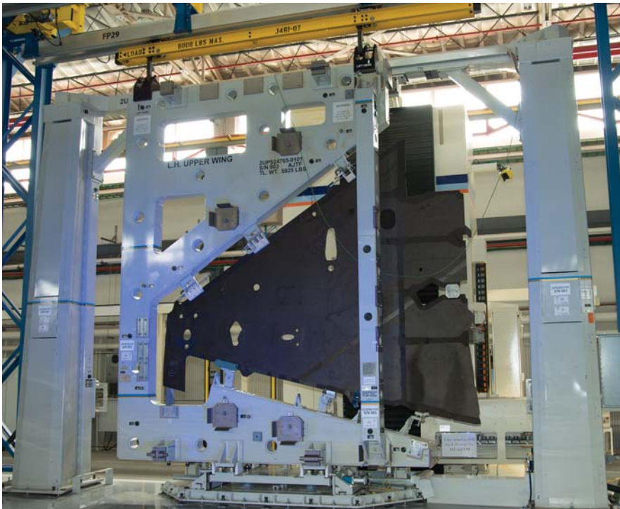
המעטה העליון של הכנף השמאלית ב-F-35 בתוך כלי הייצור שבו מבוצעים הקידוחים והחיתוכים המדויקים.
