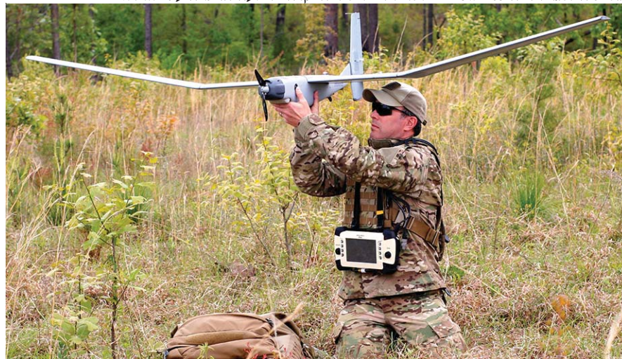
החייל המשגר את ה-ArrowLite נושא את מכשיר הבקרה ברצועה התלויה על צווארו.
