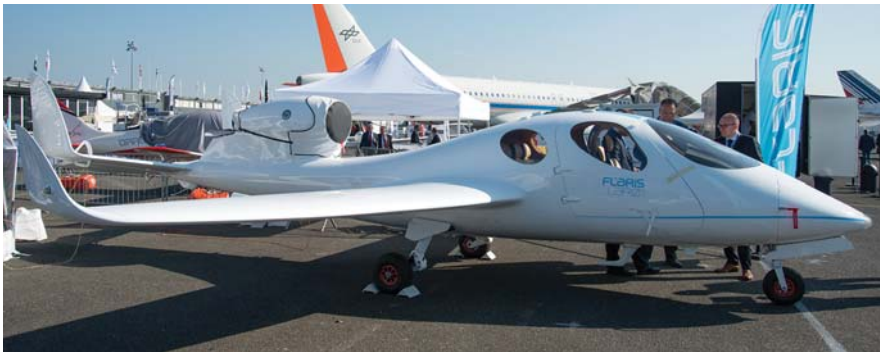
אב-טיפוס של המטוס הסילוני החד-מנועי הקל מאוד פלאריס LAR-1 שפותח בפולין.
