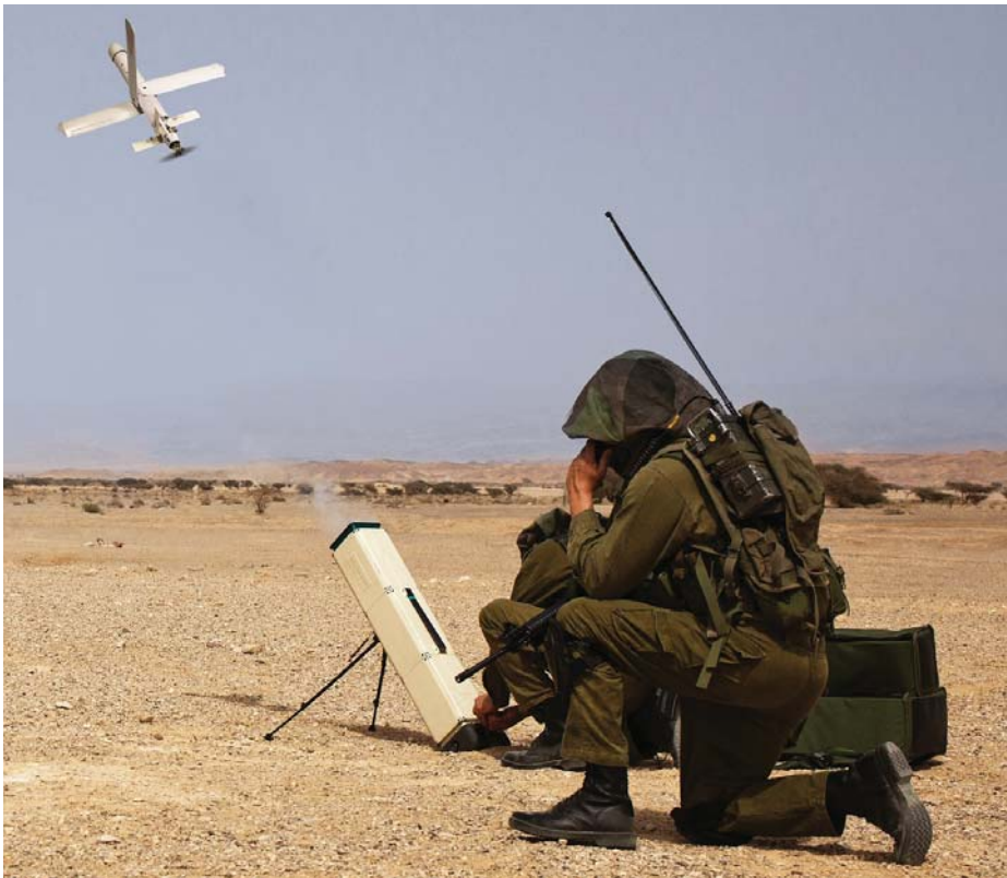
חייל נושא על גבו את החימוש המשוטט HERO 30 הארוז בתוך זביל, ומחזיק בידיו את יחידת השליטה והבקרה. הכלי המונע חשמלית מוזנק מתוך הזביל.
