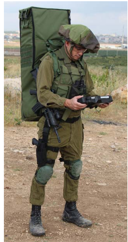
חייל נושא על גבו את החימוש המשוטט HERO 30 הארוז בתוך זביל, ומחזיק בידיו את יחידת השליטה והבקרה. הכלי המונע חשמלית מוזנק מתוך הזביל.
