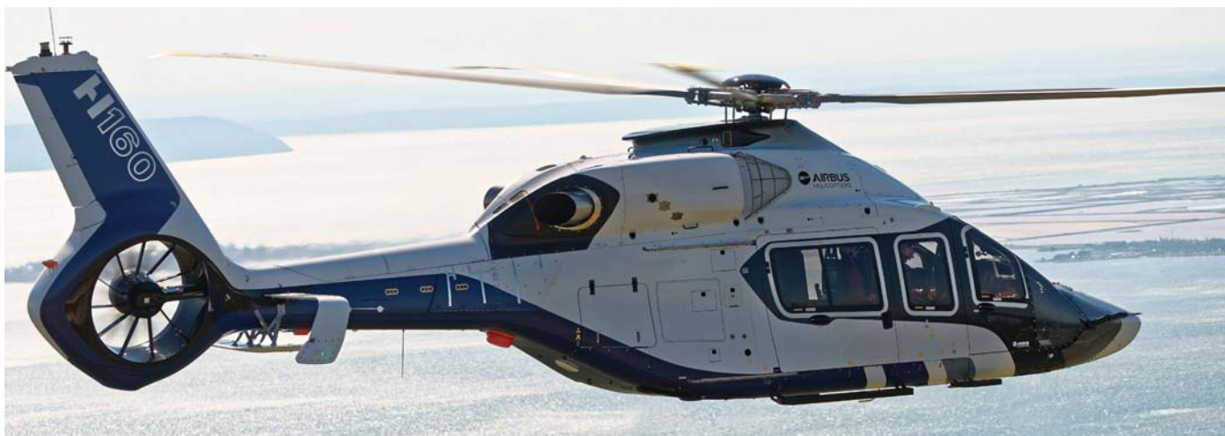
אב-הטיפוס של ה-H160 ביטסת הבכורה שלו ב-13 ביוני. הפנסטרון מוטה הצידה ב-12 מעלות, והזנב האנכי שמעליו מוטה ב-12 מעלות לכיוון הנגדי.
