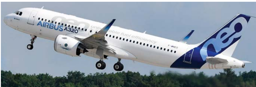
אב-הטיפוס של ה-A320neo שמצויד במנועי פראט אנד ויטני PW1100G-JM.
