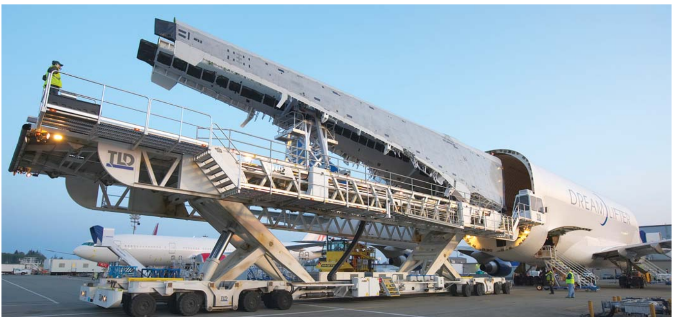
ה-747-400LCR דרימליפטר מותאם להובלת חלקי מבנה גדולים של גוף ה-787 (משמאל) או זוג כנפיים (למטה).
