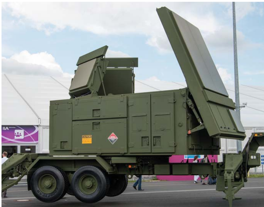
המכ"ם החדש של רייתאון שיאפשר למערכת הפטריוט לספק יכולת הגנה ב-360 מעלות.
