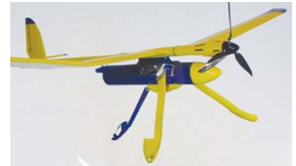
החברה הובת של אלביט מערכות בארה"ב הציגה דגם משופר של המיני-קטב"ם סקיילארק 1 (משמאל), עם שינויים בולטים לעומת רוכב שמיים הצה"ל. המטע"ד מותקן בתחתית הגוף, במקום בחרטום. לכלי-הטיס שלוש רגליים הנפרסות בעת הנחיתה (בתמונה למטה), במקום ההנחתה באמצעות מצנח על כרית אוויר מתנפחת. משולב בו מנוע חשמלי עוצמתי יותר עם מדחף תלת-להבי.
