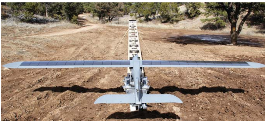
הכטב"ם הסולארי-חשמלי הקטן Silent Falcon (בז שקט) מוזנק ממעוט קרקעי פשוט.
