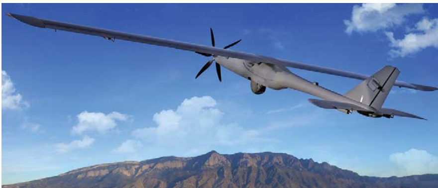
הכטב"ם הסולארי-חשמלי הקטן Silent Falcon (בז שקט) מוזנק ממעוט קרקעי פשוט.
