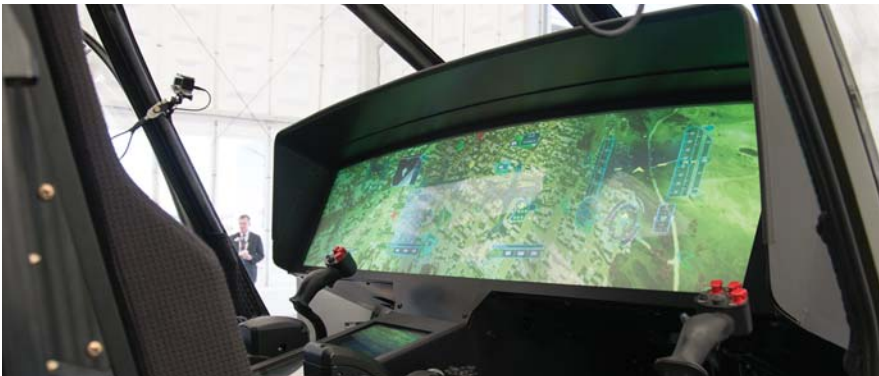
למטה: הדגם בקנה מידה מלא של ה-V-280 שהוצג על-ידי בל הליקופטר בפארנבורו. למעלה: תא הטייסים מתאפיין בצג מגע גדול שיפעל כמו טאבלט.
