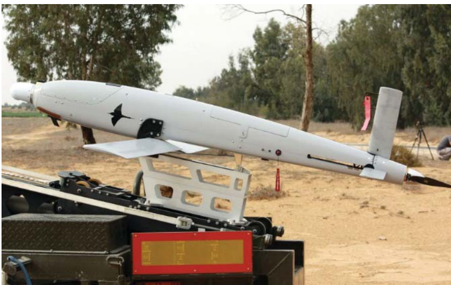
הכטב"ם SkyStriker של אלביט מערכות נושא ראש קרבי בן 5 או 10 ק"ג ומופעל כחימוש משוטט.
