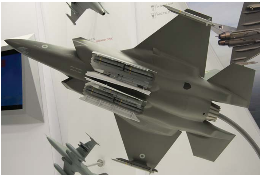
ארבעה טילי SPEAR על מנשא אחד יתאימו לנשיאה בתוך תא החימוש הפנימי של ה-F-35.
