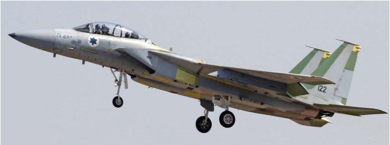
מטוס ה-F-15B מספר 110, ששוקם אחרי תאונה קשה באמצעות שימוש בגוף האחורי של F-15A מספר 314 (ראה כתבה ב"ביעף" 135 עמ' 5), חזר לטוס ב-3 בנובמבר ומסומן עתה ב-122 מספר. שמו של המטוס נותר "ראש חץ". (צילום: עופר צידון)
