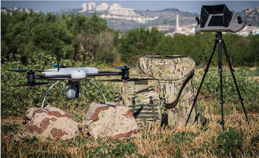
הרחפן דה'וינצ'י, יחידת השליטה והבקרה על חצובה, ותיקי הגב לנשיאת המערכת.
