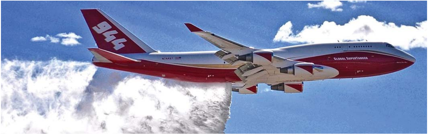
הסופר טנקר מודל 2016: בואינג 747-446(BCF) של חברת גלובל סופר טנקר מקולוראדו. למטה: פתחי הטלת המים בגחון המטוס.
