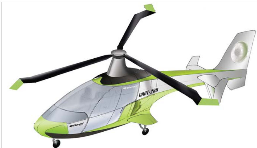
למעלה: איור של המסוק הקל DART-280 בעל ארבעה מושבים שמפתחת חברת דיאמונד. למטה: ה-DA50-V של דיאמונד מצויד במנוע דיזל SR305-260E מתוצרת סאפרן SMA.
