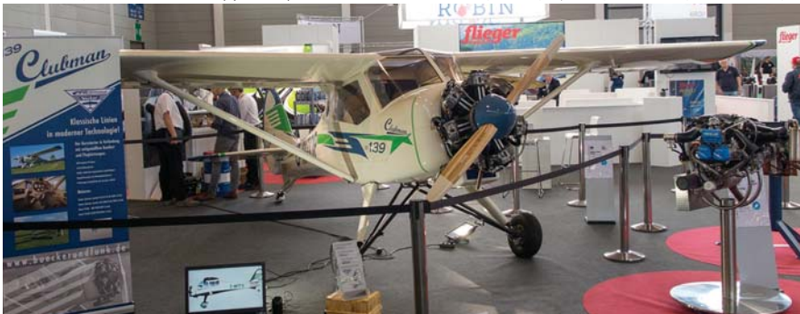
ביקר אונד פונק BF139 קלובמן קלאסיק מצויד במנוע רדיאלי. ניתן להתקי בו גם מנוע רוטקס 915iS.
