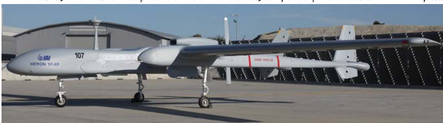
ההרון TP-XP נבדל חיצונית מן האיתן בהעדר הראדום של אנטנת התקשורת הלוויינית מעל לחרטום.
