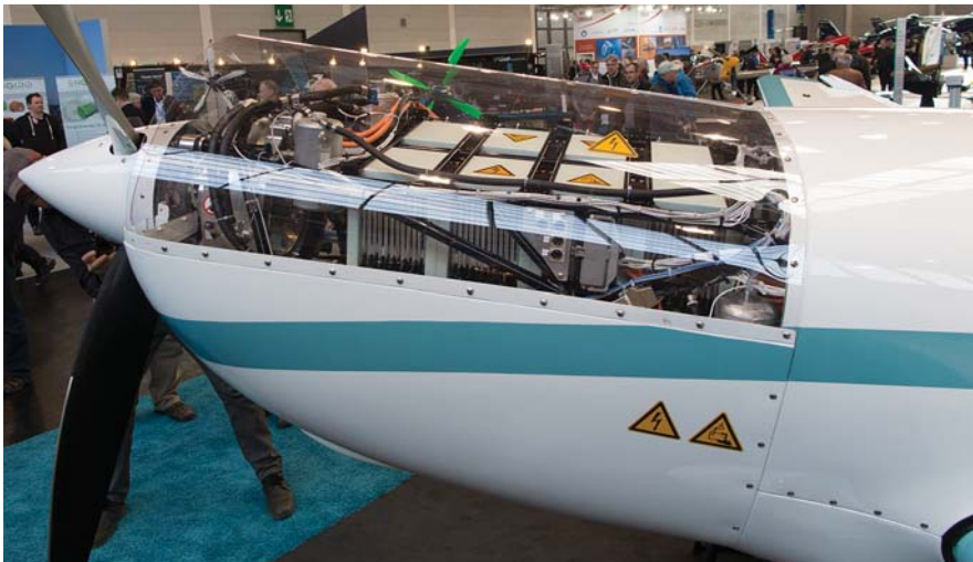
המנוע החשמלי מתוצרת סימנס ומערך המצברים בחרטום האקסטרה 330LE.
