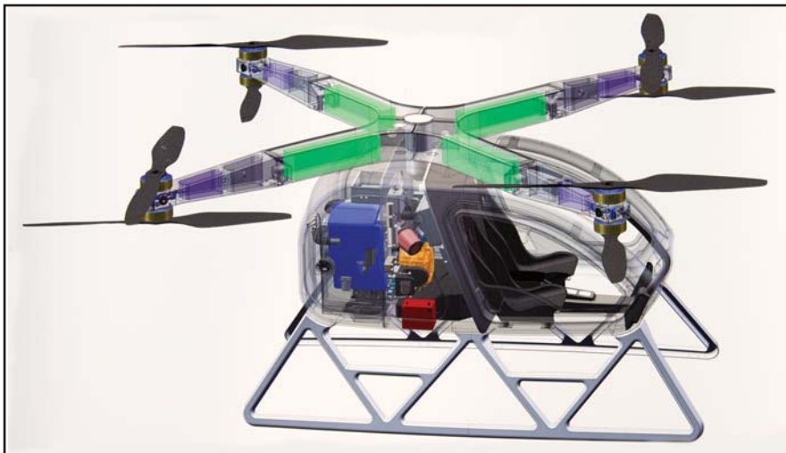
המסוק SureFly בעל 8 הרוטורים מצויד במערכת הנעה היברידית. מיקום הרכיבים נראה בצויר למעלה.
