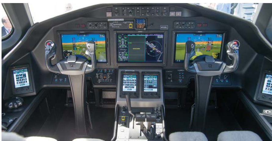
מטוס הניסוי הרביעי של הסייטישן לונגיטוד הצטרף לתוכנית ניסויי הטיסה ב-6 במאי השנה. למעלה: תא הטייסים עם מערכת האוויניקה גארמין G5000.
