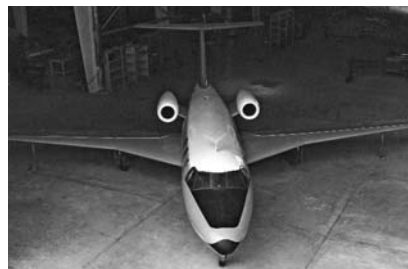
הדגם בקנה מידה מלא של ה-B-101 שתוכנן על-ידי שצקי בתע"א. למטה: תצורה B עם זנב פרפר כמו בפוגה מאגיסטר; למעלה: תצורה C עם זנב T.
