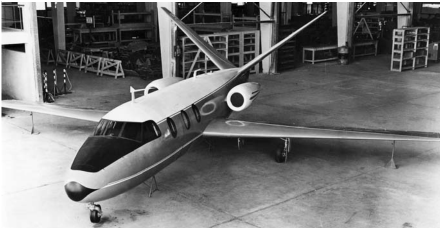
הדגם בקנה מידה מלא של ה-B-101 שתוכנן על-ידי שצקי בתע"א. למטה: תצורה B עם זנב פרפר כמו בפוגה מאגיסטר; למעלה: תצורה C עם זנב T.
