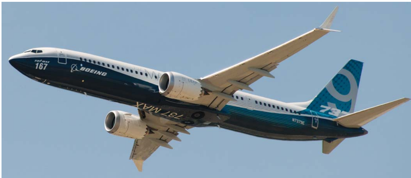
אב-הטיפוס של הבואינג 737 MAX 9 במפגן הטיסה בשמי לה-בורז'ה. המטוס משיג חסכוניות בתצורת הדלק בזכות מנועי ה-LEAP-1B וכנפוני קצות-הכנף.
