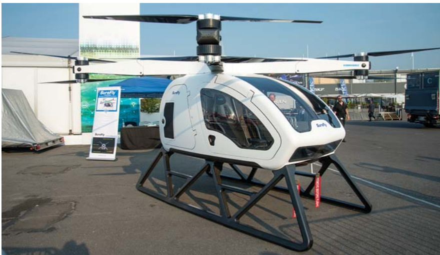
המסוק SureFly בעל 8 הרוטורים מצויד במערכת הנעה היברידית. מיקום הרכיבים נראה בצויר למעלה.
