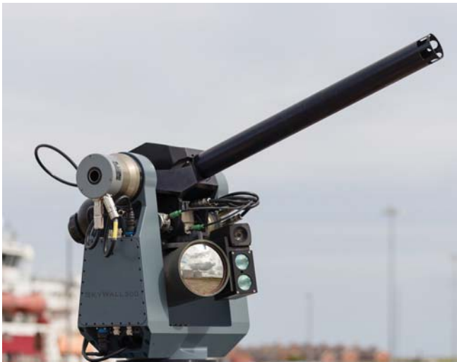
ה"תותח" של מערכת SkyWall 300 בעמדת שיגור ניחת. למטה: פריסת הרשת מתוך הקליע הנפתח באוויר.
