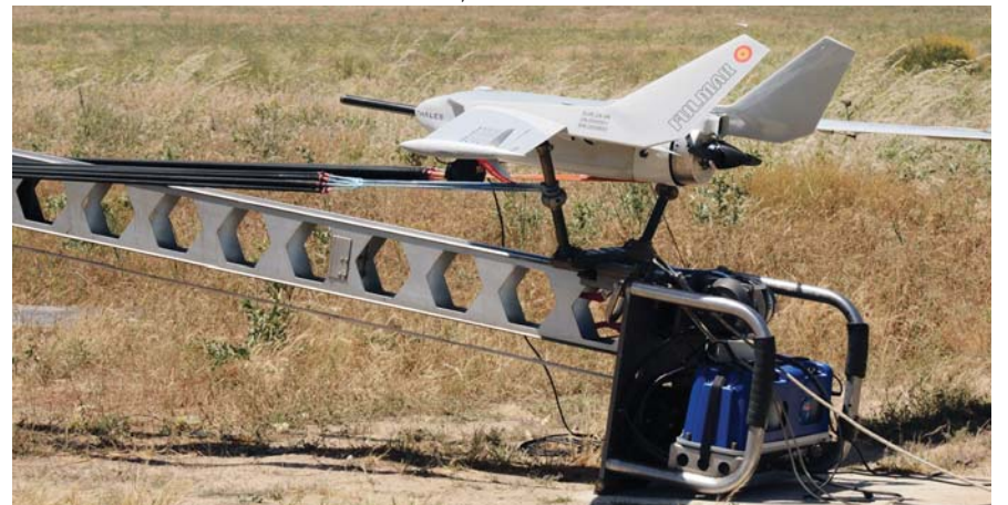
המיני-כטב"ם Fulmar X משוגר ממעוט ובתום טיסתו נקלט ברשת (בתמונה משמאל).
