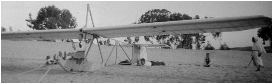
למעלה: חלקי הדאון פוהו G-35 בבית מלאכה ביריד המזרח בתל-אביב. למטה: פוהורילה בניסויי שטח לאיזון כנפי הדאון בחולות ראשון לציון. (מאוסף דני שלום)
