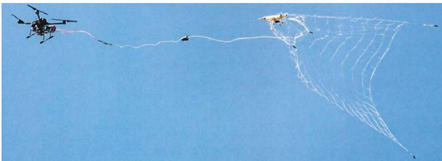
למטה: ה- DroneCatcher של Delft Dynamics בתערוכה. למעלה: פריסת הרשת לתפיסת הרחפן הפולש.
