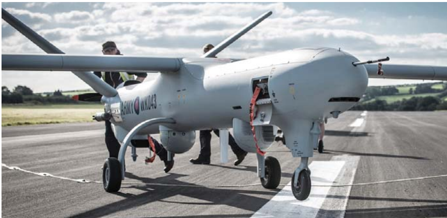
הכטב"ם הטקטי Watchkeeper של הצבא הבריטי נושא מטע"ד אלקטרו-אופטי ומכ"ם I-Master.
