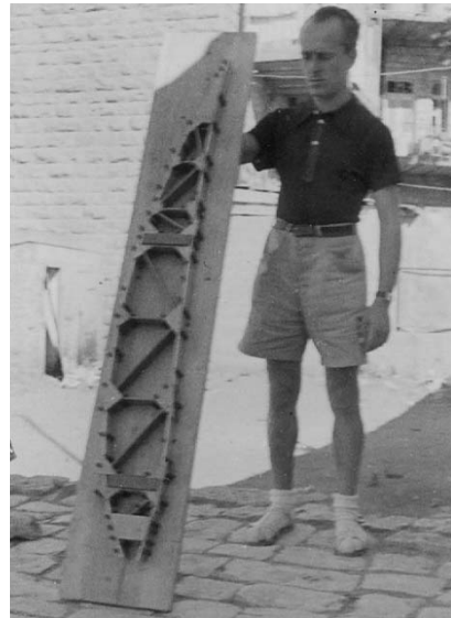
פוהורילה מציג צלע של כנף הפוהו G-35 בשלבי בנייה בירושלים. (מאוסף פרופ' נפתלי קדמון)
