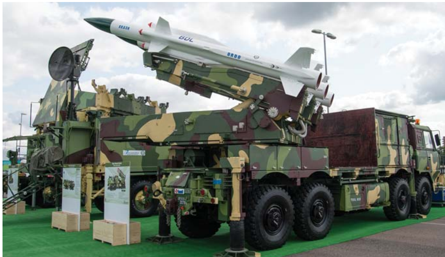
משגר עם שלושה טילי אקאש על משאית טאטא. המכ"ם של המערכת נראה משמאל על משאית אחרת.
