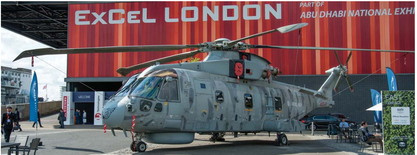
מסוק אגוסטה-ווסטלנד AW101 מרלין HM Mk2 ללוחמה בצוללות מחוץ לאולם התערוכה. למטה: מרלין HC Mk4 לתובלת כוחות קומנדו של חיל הנחתים.
