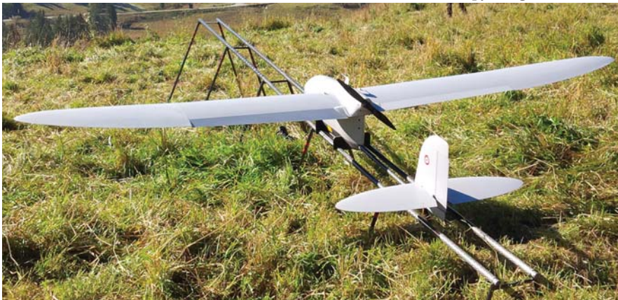
המיני-כטב"ם Fulmar X משוגר ממעוט ובתום טיסתו נקלט ברשת (בתמונה משמאל).
