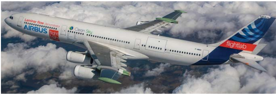
האירבאס A340-300 כמעבדת טיסה עם קטעי כנף חיצוניים חדשים לבחינת זרימה למינארית.
