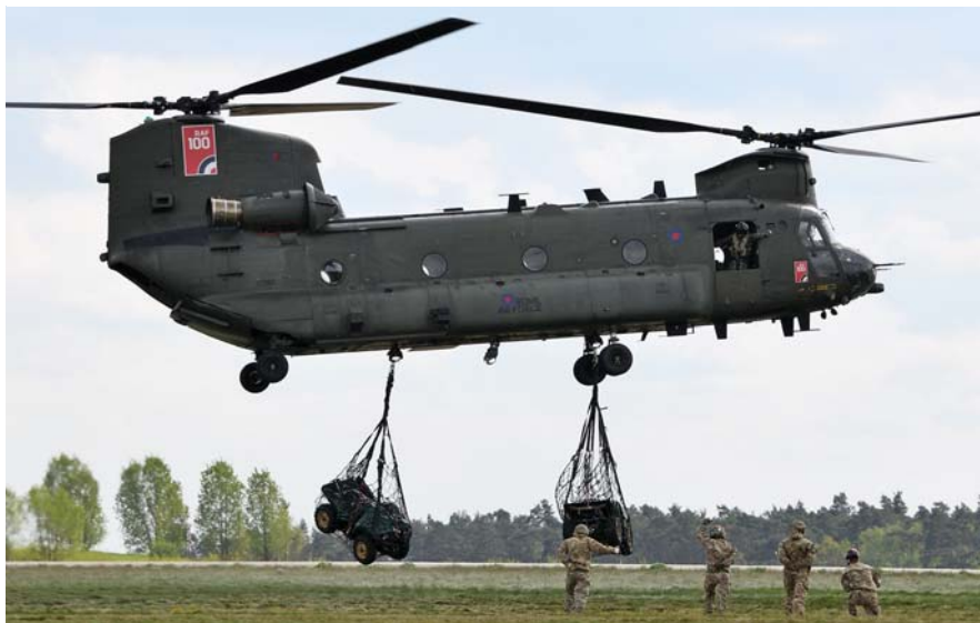
שינוק בריטי מדגם HC Mk.4 הדגים ב-ILA נשיאת מטענים חיצוניים על שלוש נקודות התלייה בחונו.
