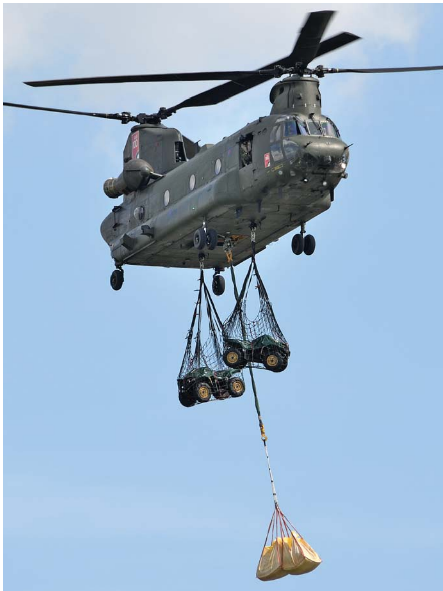
שינוק בריטי מדגם HC Mk.4 הדגים ב-ILA נשיאת מטענים חיצוניים על שלוש נקודות התלייה בחונו.
