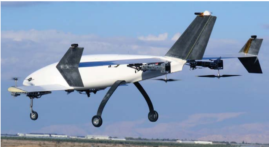
מבטים מלפנים ומאחור על הפרס 2 בטיסת ריחוף, כאשר המדחפים/רוטורים מוטים כלפי מעלה ומטה.
