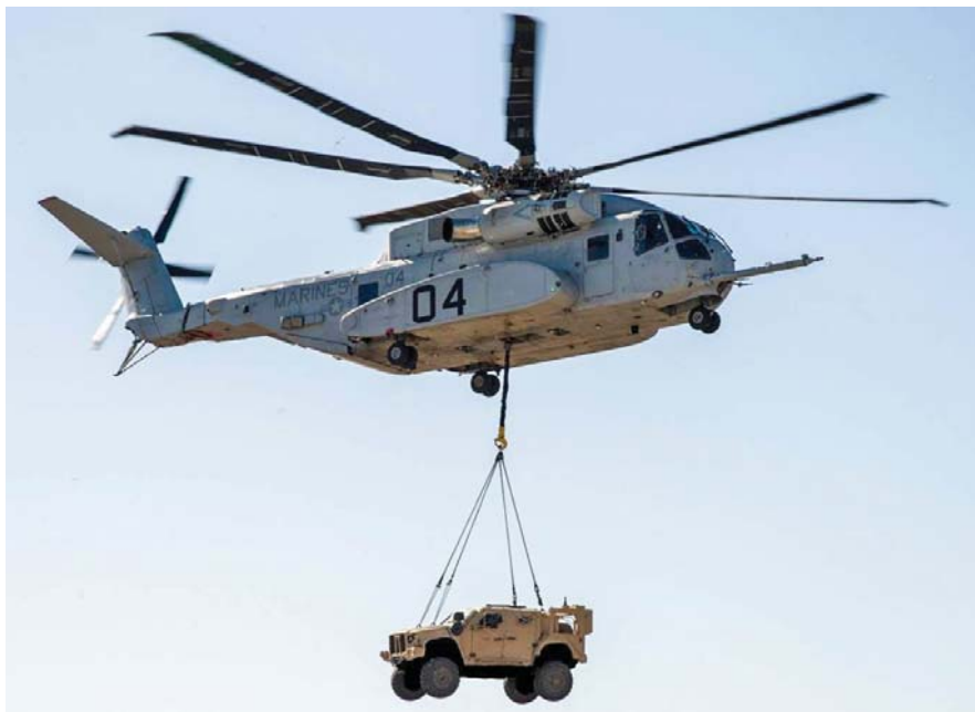
מסוק הניסוי הרביעי של ה-CH-53K הדגים בארה"ב נשיאה חיצונית של כלירכב צבאי מסוג JLTV.
