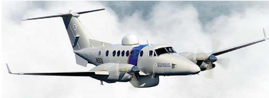
קינג אייר 350ER מצויד במכ"ם בגחוונו, שסופק לסוכנות המכס והגנת הגבולות של ארה"ב.
