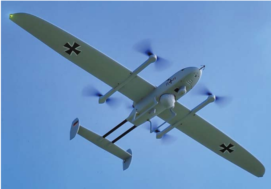
דגם ניסיוני של הכטב"ם לונה NG שהותאם להמראה ונחיתה אנכית בהוספת 4 רוטורים מונעים חשמליים.
