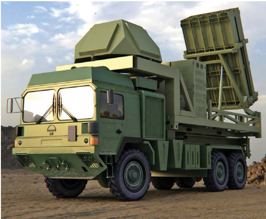
כל רכיבי כיפת ברזל הותקנו על משאית אחת כדי ליצור את המערכת הניידת I-Dome .
