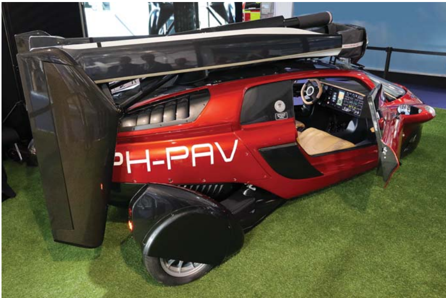
למעלה: הליברטי בתצורת מכונית לנסיעה בכבישים, עם זנב ורוטור מקופלים, כפי שהוצג בפארנבורו. למטה: הכלי בתצורת ג'יירופלן לטיסה.
