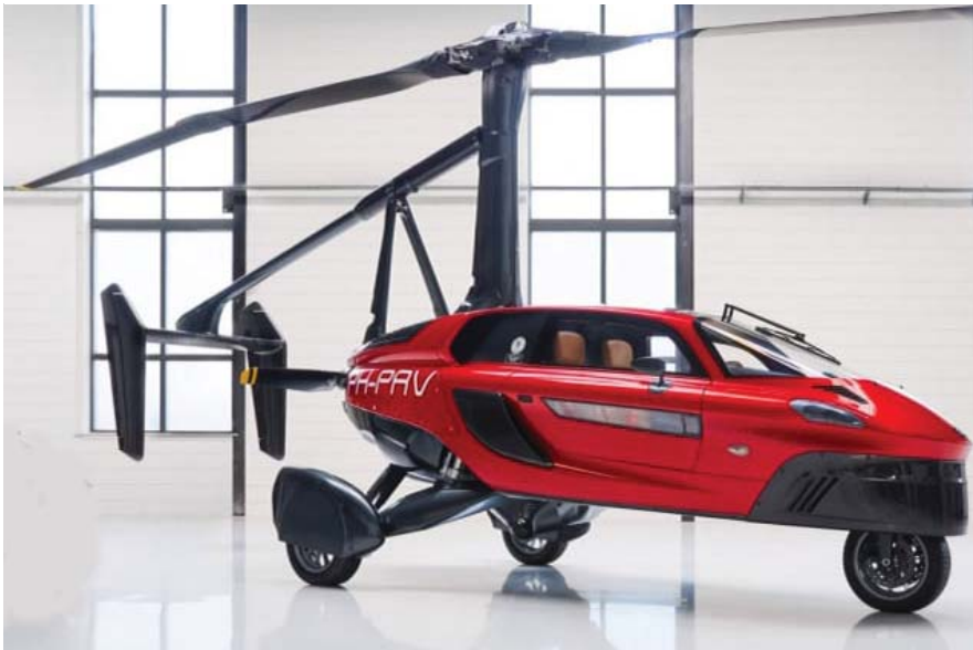
למעלה: הליברטי בתצורת מכונית לנסיעה בכבישים, עם זנב ורוטור מקופלים, כפי שהוצג בפארנבורו. למטה: הכלי בתצורת ג'יירופלן לטיסה.
