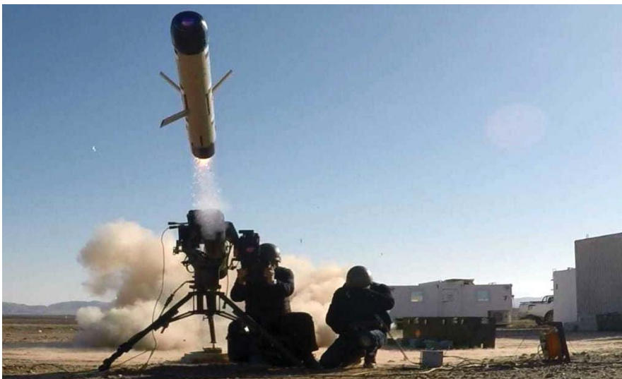
הטיל ספייק ER2 של רפאל מוזנק ממשגר קרקעי באחד מהניסויים שנערכו בארץ.
