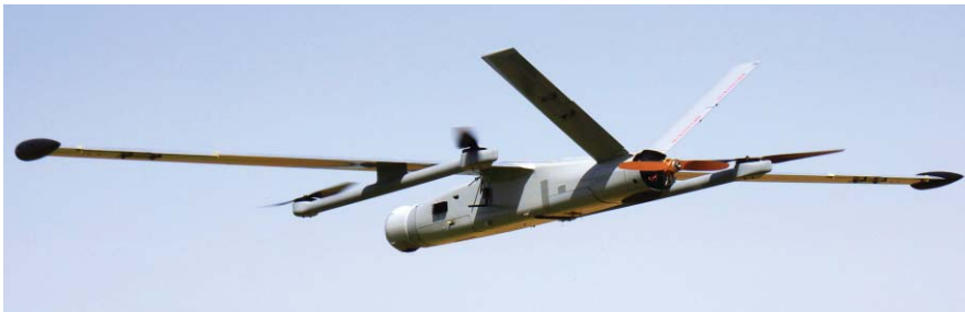
למעלה: ה-ThunderB הותאם להמראה ונחיתה אנכית באמצעות שני זוגות של מנועים חשמליים שמסובבים רוטורים קטנים. למטה: המיני-כטב"ם SpyLite משוגר ממעוט באזור הררי בהודו.
