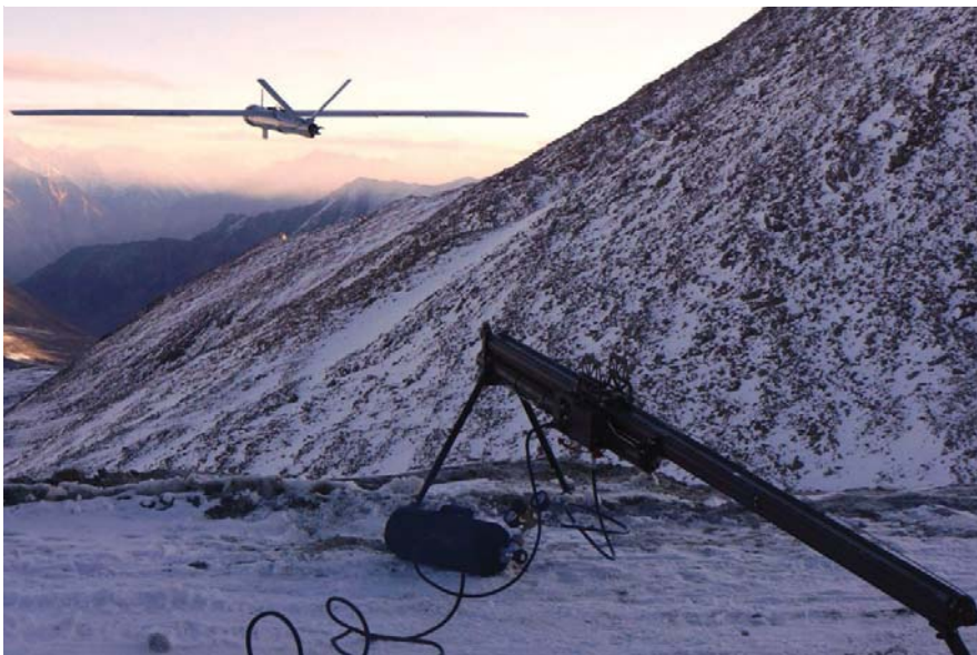
למעלה: ה-ThunderB הותאם להמראה ונחיתה אנכית באמצעות שני זוגות של מנועים חשמליים שמסובבים רוטורים קטנים. למטה: המיני-כטב"ם SpyLite משוגר ממעוט באזור הררי בהודו.
