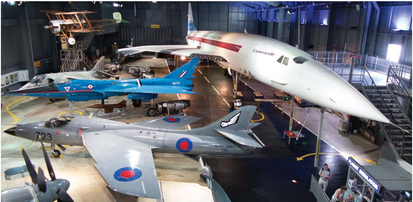
למעלה מימין: אב-הטיפוס הבריטי הראשון של הקונקורד (002), שהוטס מ-1969 עד 1976. המטוס הכחול משמאל: BAC 221 – מטוס ניסוי לפיתוח תצורת הכנף של הקונקורד, אשר הוטב מהפיירי דלתא 2, וביצע 273 גיחות מ-1964 עד 1973. בקדמת התמונה: הוקר האנטר דר-מושבי T.8M. למטה: מבנה המוזיאון מבחוץ.
