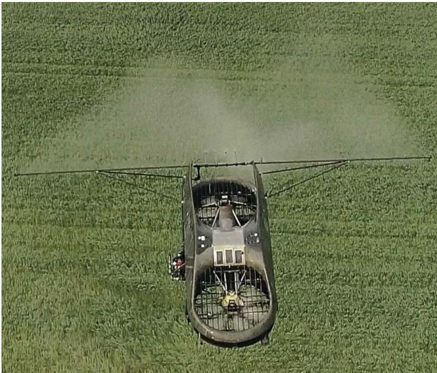
הכטב"ם קורמורן של טקטיקל רובוטיקס (אורבן איירונאוטיקס) מדגים ריסוס שדה חקלאי.
