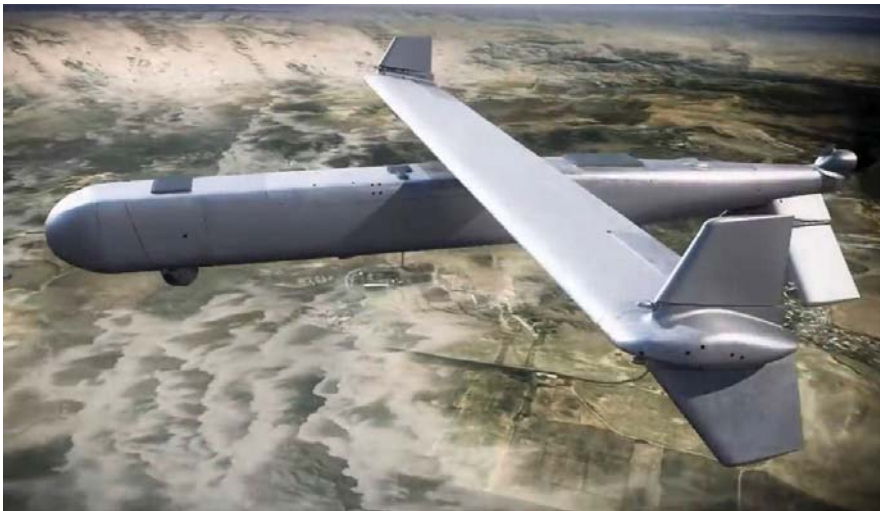
המיני-הארפי בתצורת שיטוט לעבר אזור המטרה, לאחר שהכנף נפרסה בניצב לגוף.
