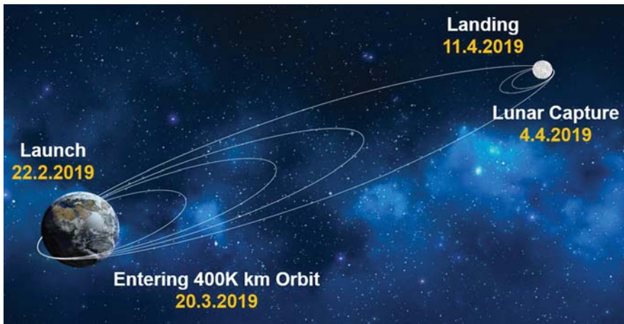
דרכה של בראשית לירח נעשתה על-ידי הגדלת המסלולים האליפטיים עד ללכידה בכוח המשיכה של הירח.
