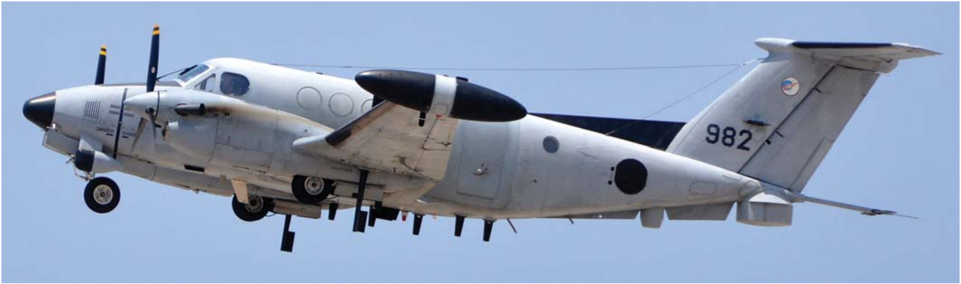
ביצ'קראפט RC-12D (גרסה צבאית של הסופר קינג אייר A200CT) קוקייה 1 עם שלל אנטנות לאיסוף מודיעין תקשורת ומודיעין אותות.
