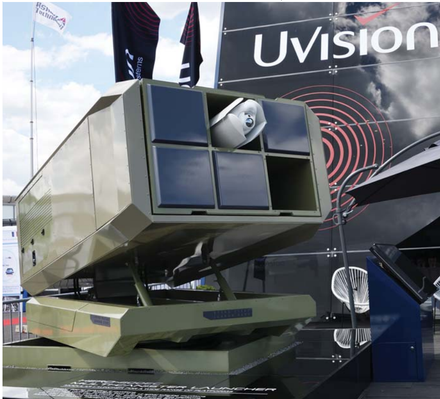
למעלה: החימושים המשוטטים בעלי ההנעה החשמלית מדגמי Hero-30, Hero-120 ו-Hero-400EC. למטה: המשגר עם שישה זבילים להזנקת ה-Hero-400EC.
