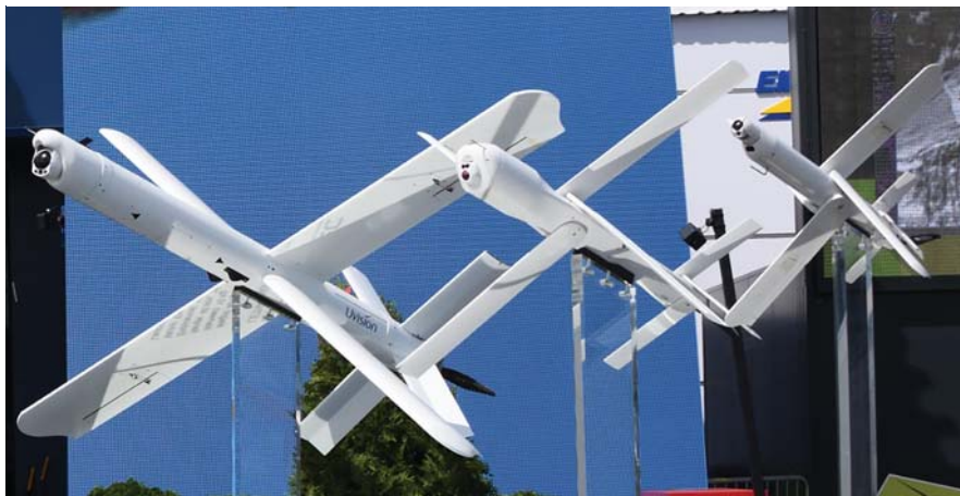
למעלה: החימושים המשוטטים בעלי ההנעה החשמלית מדגמי Hero-30, Hero-120 ו-Hero-400EC. למטה: המשגר עם שישה זבילים להזנקת ה-Hero-400EC.
