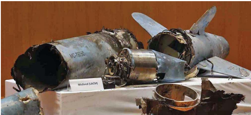
השברים שהציגו הסעודים אחרי תקיפת מתקני הנפט בספטמבר נראים תואמים לטיל השיוט האיראני קודס-1, שנראה למטה בעת הצגתו על-ידי הח'ותים בתימן בחודש יולי השנה, עם המנוע הקטן TJJ100.
