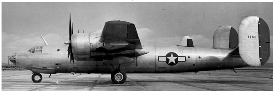
למעלה: הקונווייר B-36. למטה: אב-הטיפוס XB-32 עם שני מייצבי הכיוון הקטנים מדי, שלא סיפקו יציבות רוחבית מספקת. תצורה זו הוחלפה במייצב כיוון יחיד גדול, כמו ב-B-29.
