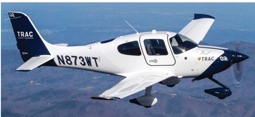
סירוס איירקראפט מציעה מטוס אימון מותאם להדרכה המכונה TRAC, שמבוסס על ה-SR20, אשר מצויד במערכת האוויוניקה פרספקטיב+ של גארמין בתוספת לוח מקשים להכנסת נתונים למערכת ניהול הטיסה.
