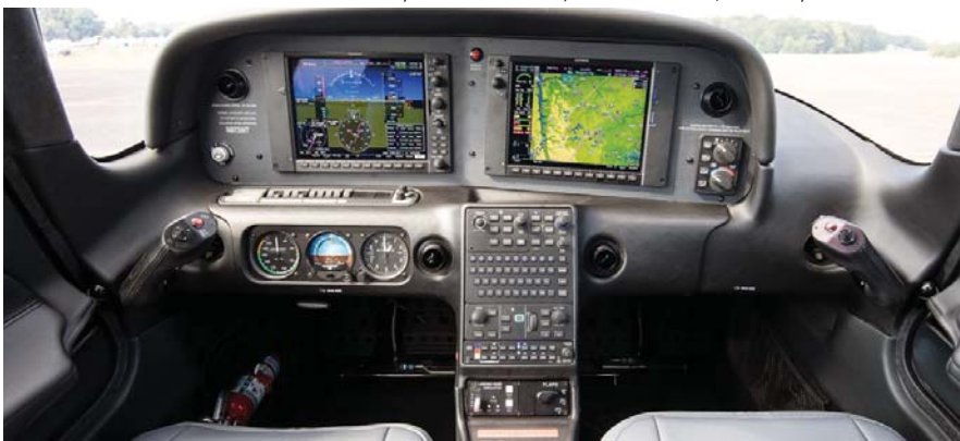
סירוס איירקראפט מציעה מטוס אימון מותאם להדרכה המכונה TRAC, שמבוסס על ה-SR20, אשר מצויד במערכת האוויוניקה פרספקטיב+ של גארמין בתוספת לוח מקשים להכנסת נתונים למערכת ניהול הטיסה.
