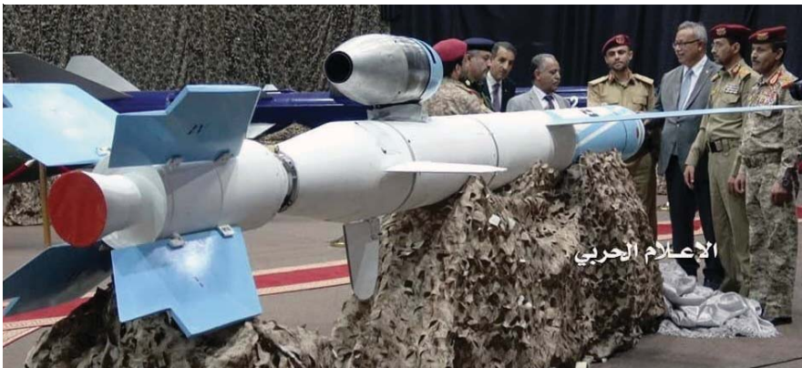
השברים שהציגו הסעודים אחרי תקיפת מתקני הנפט בספטמבר נראים תואמים לטיל השיוט האיראני קודס-1, שנראה למטה בעת הצגתו על-ידי הח'ותים בתימן בחודש יולי השנה, עם המנוע הקטן TJJ100.
