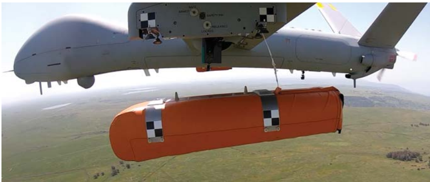
הרמס 900 נושא ארבע רפסודות מתנפחות במתלים מתחת לכנפיו. למעלה: ניסוי שחרור של רפסודה מתחת לכנפי הכטב"ם.
