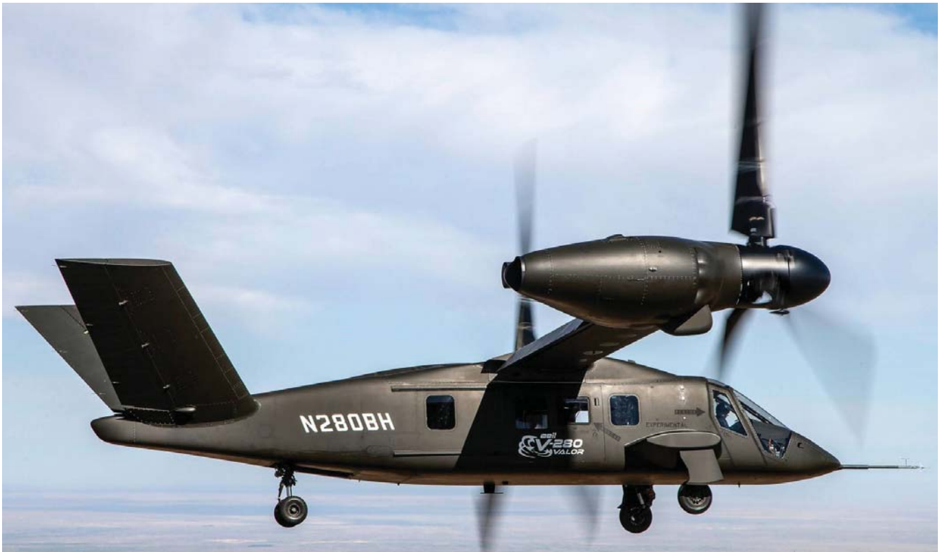
אב-הטיפוס של הבל V-280 ולור בטיסה אופקית (למעלה) ובריחוף (למטה). רק הרוטורים מסתובבים ממצב אנכי לאופקי וחזרה, בעוד המנועים נשארים קבועים.
