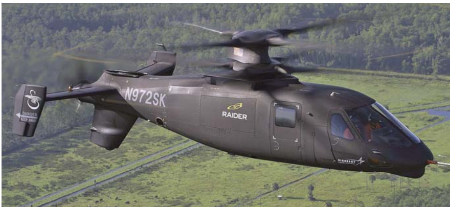
ה-S-97 ריידר, שהחל לטוס במאי 2015, משמש כאב-טיפוס למסוק טקטי קל, תוך ניצול טכנולוגיית X2.
