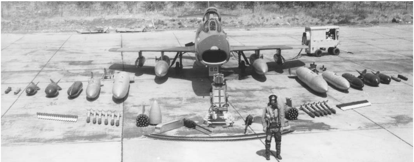
סמב"ד 60 מדגים את אפשרויות החימוש למשימות תקיפה, עם מכלי דלק נתיקים (בידונים), פצצות במשקלים שונים, רקטות ופגזים לתותחי הדפה בקוטר 30 מ"מ.
