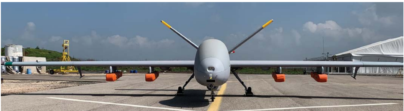
הרמס 900 נושא ארבע רפסודות מתנפחות במתלים מתחת לכנפיו. למעלה: ניסוי שחרור של רפסודה מתחת לכנפי הכטב"ם.
