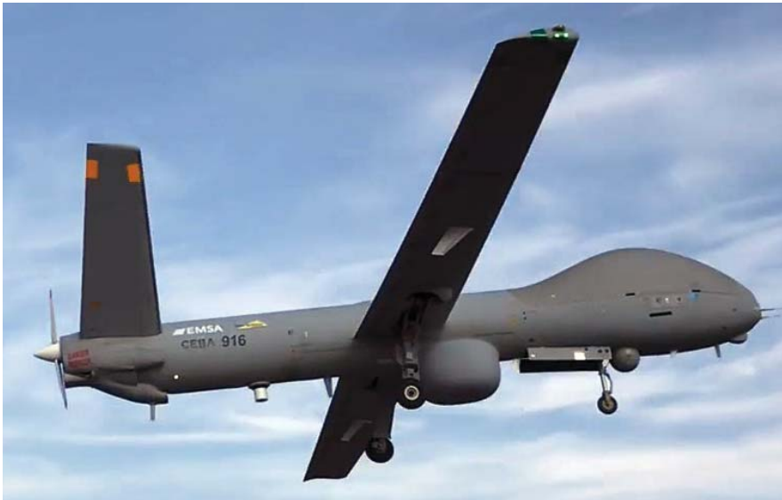
הרמס 900 לסיור ימי, עם מכ"ם בגחוני, שהוחקר לסוכנות האירופית לבטיחות ימית EMSA.
