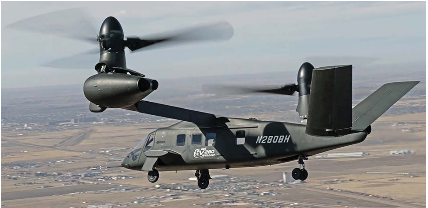
אב-הטיפוס של הבל V-280 ולור בטיסה אופקית (למעלה) ובריחוף (למטה). רק הרוטורים מסתובבים ממצב אנכי לאופקי וחזרה, בעוד המנועים נשארים קבועים.
