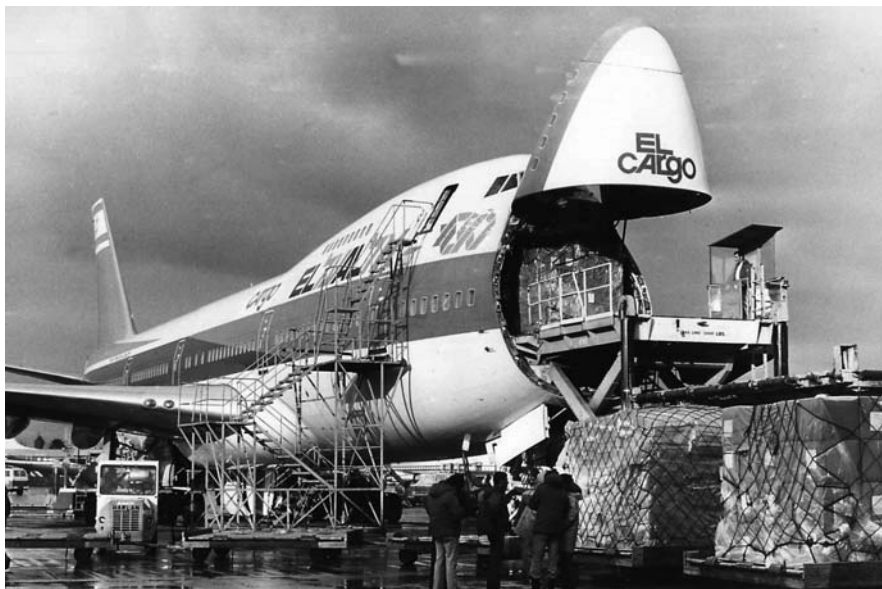
מטוס המטען היסיב 4X-AXD אפשר הטענת מטענים ופריקתם בצורה נוחה דרך החרטום הנפתח.
