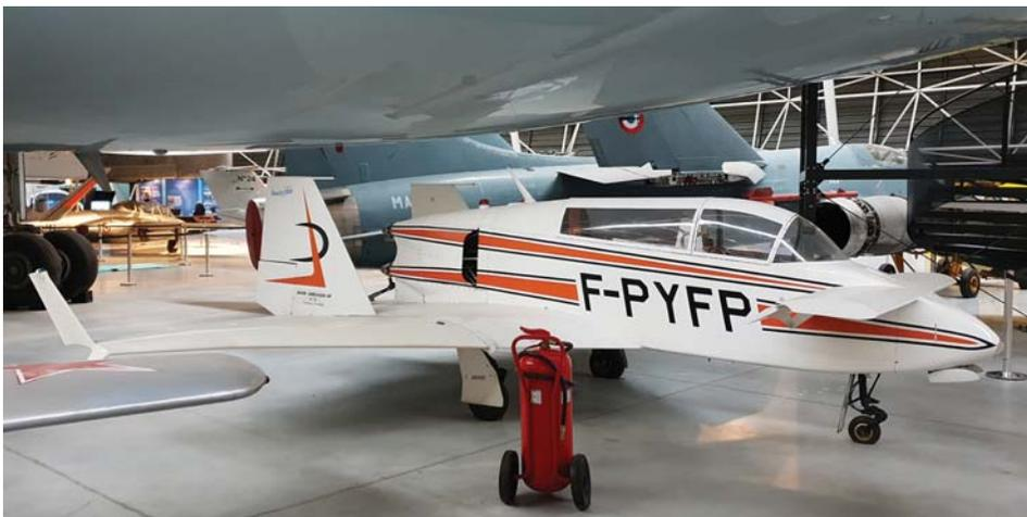
משמאל: Microstar VariViggen. גרסה יחידה מסוגה זו של המטוס בתצורת קנארד מצוידת בשני מנועי סילון זעירים מדגם מיקרוטורבו 18, האחד מעל השני, במקום מנוע הבוכנה לייקומינג O-320 שהותקן במטוס המקורי שתיכן ברט רוטאן.
