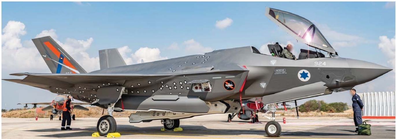
אדיר 924 עם הגיעו לתל-נוף. הסימונים הלבנים על גוף המטוס מיועדים לשמש כנקודות ייחוס בתהליכי הצילום בניסויי טיסה. (צילומים: עמית אגרונוב, חיל האוויר)
