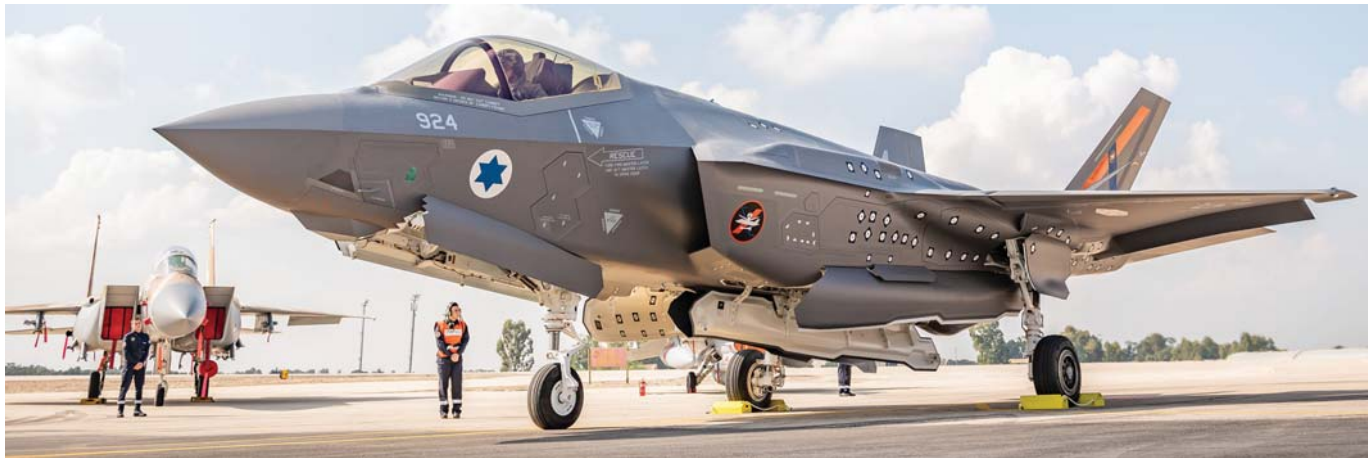
אדיר 924 עם הגיעו לתל-נוף. הסימונים הלבנים על גוף המטוס מיועדים לשמש כנקודות ייחוס בתהליכי הצילום בניסויי טיסה. (צילומים: עמית אגרונוב, חיל האוויר)
