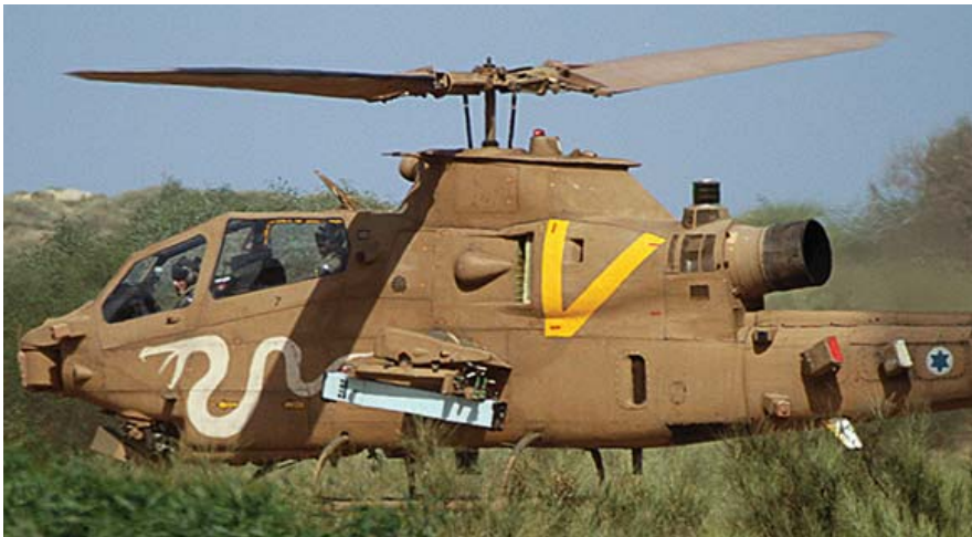
מסוק בל AH-1F קוברא (צפע ג') של חיל האוויר שהותאם לתצורת מחצלת לשיגור טילי תמוז.
