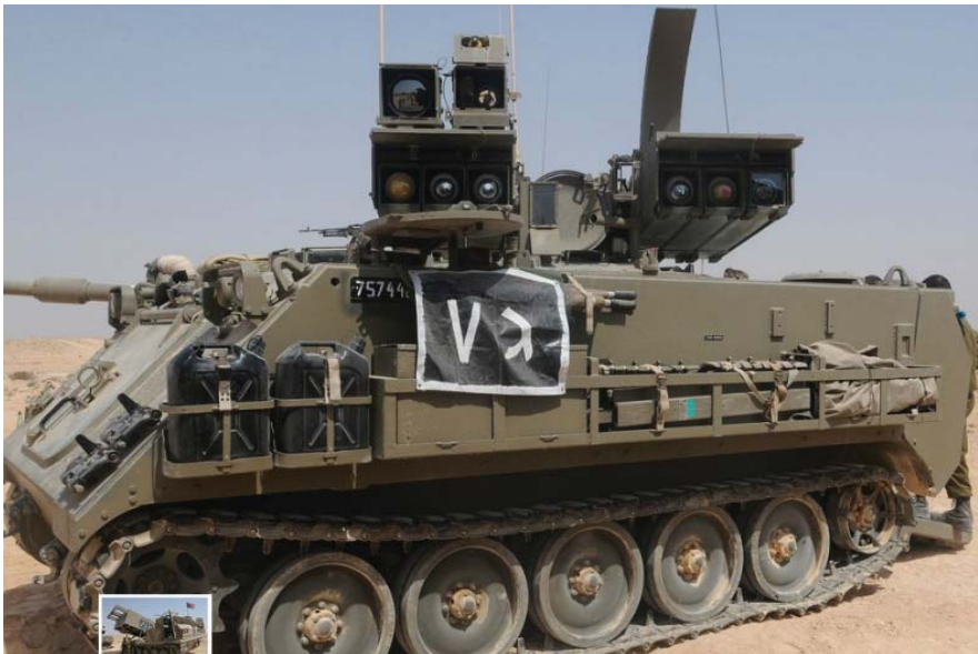
למעלה: המשגר חפיז על נגמ"ש M113 עם טילי תמוז. למטה: הטנק המוסב פרא משגר טיל תמוז.
