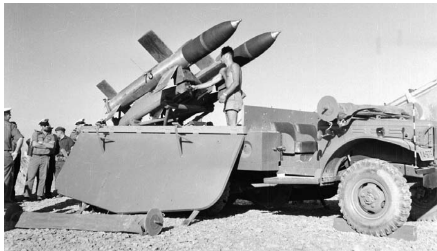
זוג טילי לוז עם ראש קרבי מוכנים לירי ממסגר מבצעי על קומנדקר בשנת 1960.
