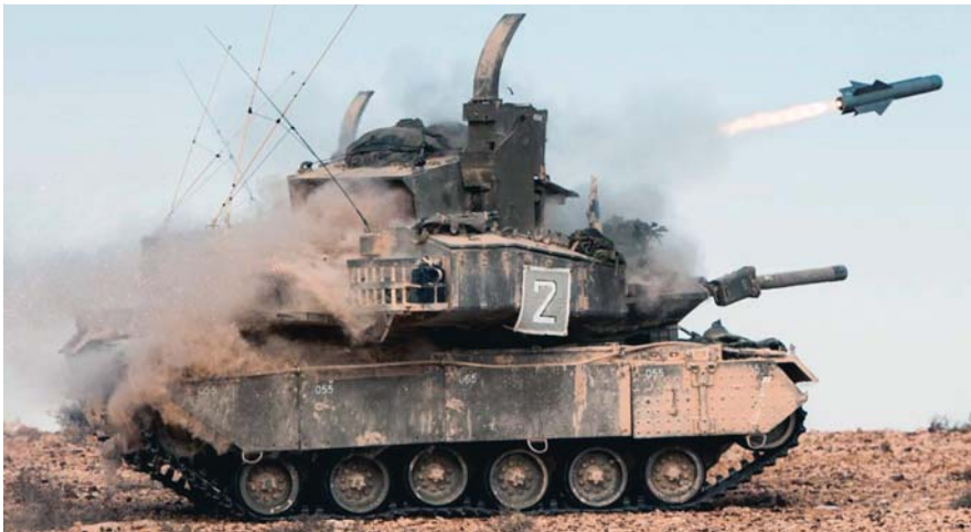
למעלה: המשגר חפיז על נגמ"ש M113 עם טילי תמוז. למטה: הטנק המוסב פרא משגר טיל תמוז.
