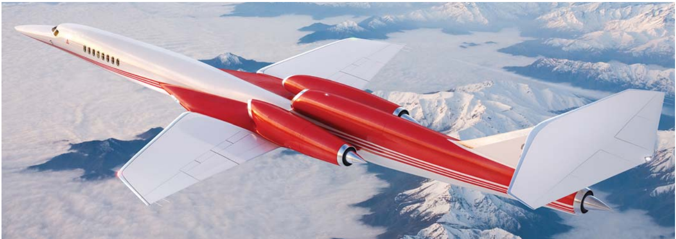
התצורה המקורית של האריון AS2 עם כנף ישרה וזנב T. בתמונת הכותרת לכתבה: התצורה המעודכנת עם כנף בצורת חץ ושני מנועים התלויים מתחת לכנף.
