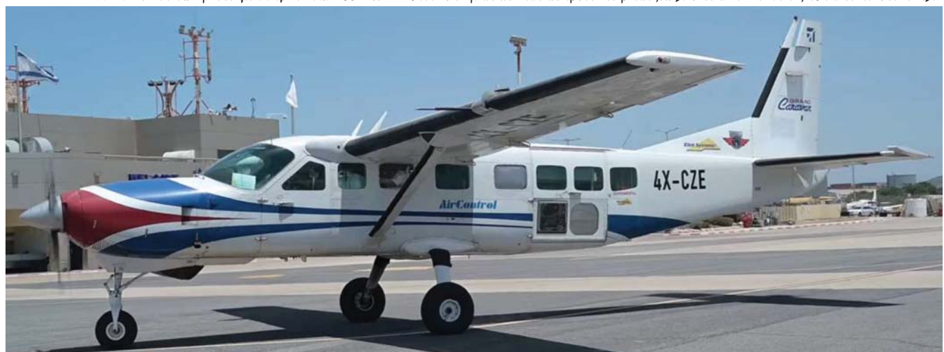
מערכת הלייזר המוטסת, שנראית בתמונה למעלה, הותקנה בחלקו האחורי התחתון של מטוס ססנה 208B גראנד קאראוון השייך לחברת לייפאיר.
