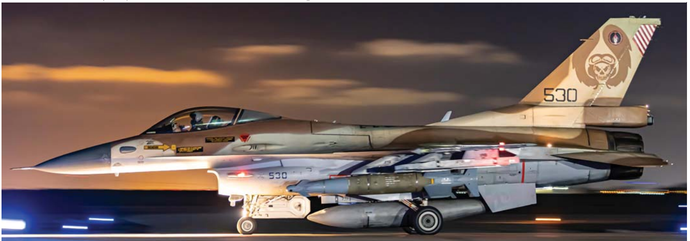
למעלה: F-16D ברק 2 של טייסת 105 העקרב נושא פצצת ברד כבד (JDAM) – פצצת ברזל במשקל 900 ק"ג שאליה חוברה ערכת נחיה לניווט לווייני (GPS). למטה: F-16C ברק 2 של טייסת 101 הקרב הראשונה נושא פצצת ברד פלדה (Spice 2000) מתוצרת רפאל, המונחת באמצעות חיישן אלקטרו-אופטי.
