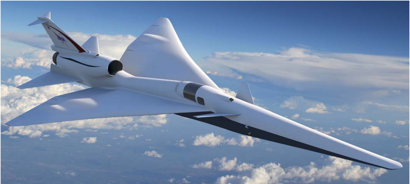
איור של ה-X-59, שייבחן בטיסה פתרון להחלשת הבום העל-קולי. מטוס הניסוי מתאפיין בחרטום ארוך מאוד עם קצה קדמי פחוס.
