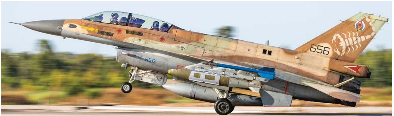
למעלה: F-16D ברק 2 של טייסת 105 העקרב נושא פצצת ברד כבד (JDAM) – פצצת ברזל במשקל 900 ק"ג שאליה חוברה ערכת נחיה לניווט לווייני (GPS). למטה: F-16C ברק 2 של טייסת 101 הקרב הראשונה נושא פצצת ברד פלדה (Spice 2000) מתוצרת רפאל, המונחת באמצעות חיישן אלקטרו-אופטי.
