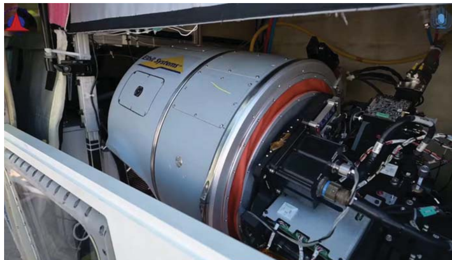
מערכת הלייזר המוטסת, שנראית בתמונה למעלה, הותקנה בחלקו האחורי התחתון של מטוס ססנה 208B גראנד קאראוון השייך לחברת לייפאיר.
