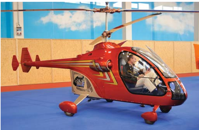
המסוק הקל Dioferr Diora מהונגריה בעל שני רוטורים הסובבים בכיוונים מנוגדים על ציר משותף (קראקסאיליים).
