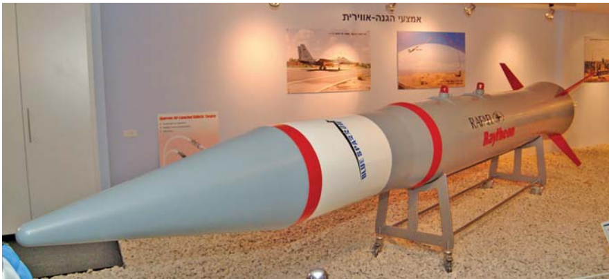
נאקור כחול – טיל מטרה משוגר ממטוס לניסויי יירוט של טילים נגד טילים בליסטיים. למטה: רג'מנט – פצצה אווירית לחדירת ביצורים. הפיתוח בוטל ב-1982 בגלל חוסר כדאיות.
