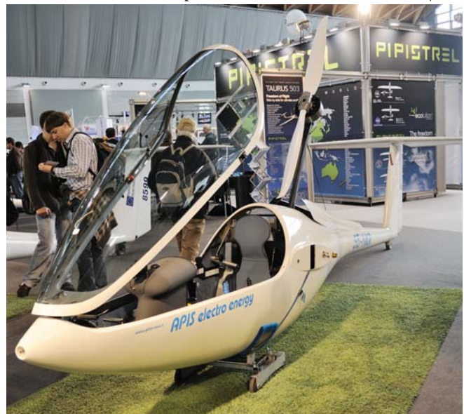
הדאון Bee-EA1 של החברה הסלובנית Pipistrel עם מנוע עזר חשמלי.
