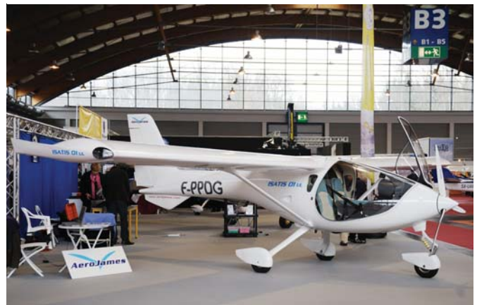
למטוס הזעיר ISATIS 01 מתוצרת החברה הצרפתית AeroJames יש תצורה ייחודית: המנוע ממוקם מאחורי תא הנוסעים, כך שלטיסים יש ראות מצוינת.
