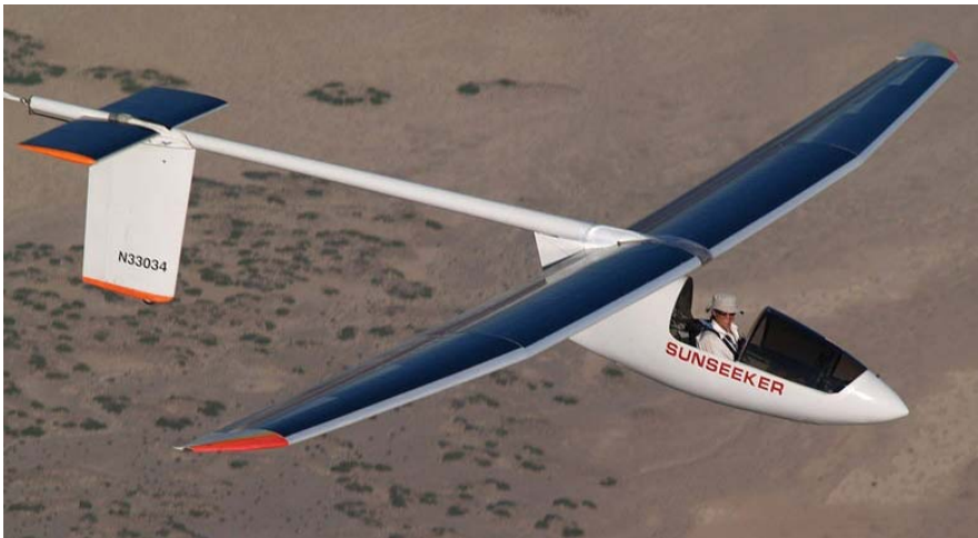
הסאנסיקר 2 בטיסה. התאים הסולאריים על הכנף, הנראים למטה, מטעינים את המצברים ומזינים את המנוע החשמלי.
