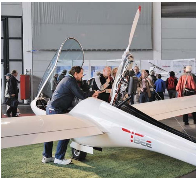
אותו דאון Bee עם מנוע עזר רגיל מסוג שריפה פנימית.
