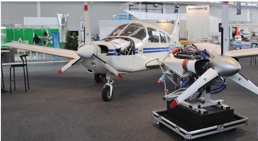
מנוע הדיזל סנטוריון 2.0 של תילרט הותקן גם בפיפר PA-28R ווריור 3.
